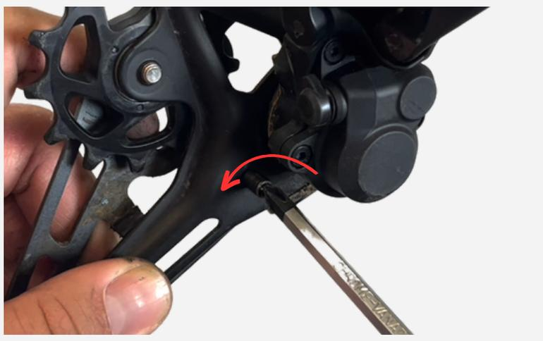
5. Faites basculer la cage dans le sens des aiguilles d'une montre jusqu'à ce qu'il n'y ait plus de tension.
