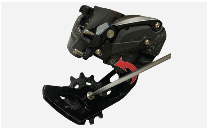
4. Remplacez le galet SRAM par le second galet Nova Ride. Vissez le avec la vis M5x16 fournie dans la boîte et la clé Allen.
