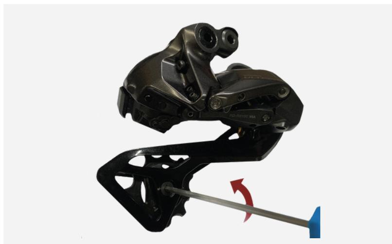
4. Insérez le galet Nova Ride et vissez le avec la seconde vis M5x16 fournie.
