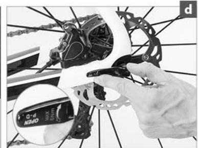
Achten Sie bei allen Systemen gleichermaßen bei der Montage auf saubere Steckachsen, Radaufnahmen in Gabel und Naben. Reinigen Sie die Bauteile ggf. mit einem saugenden Lappen und eventuell unter Zuhilfenahme von Wasser mit etwas Spülmittel. Wenn die Einstellung und Radfixierung nicht wie beschrieben funktioniert, konsultieren Sie Ihre Fahrrad XXL Filiale.
