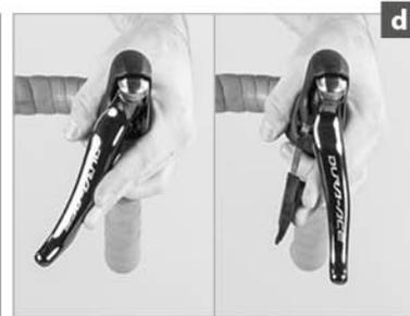
Die Anordnung und Betätigung der Schalthebel ist wie bei der mechanischen Schaltung: Anstatt wie bei herkömmlichen Dual Control-Schalthebeln von Shimano den gesamten Bremshebel oder den dahinter liegenden Hebel nach innen zu schwenken, müssen Sie bei der Di2 lediglich Bedientasten antippen.
