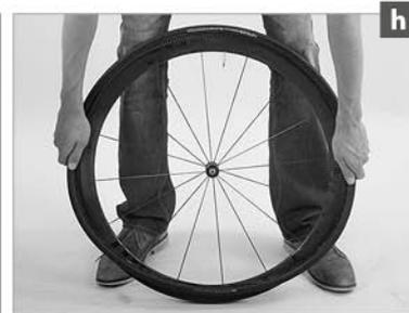
Halten Sie den Reifen unter Spannung, indem Sie die Finger an der Felge und die Daumen am Reifen abstützen und setzen Sie das Laufrad an der Hüfte ab. Drücken Sie den Reifen mit beiden Daumen über den Felgenrand (a).
