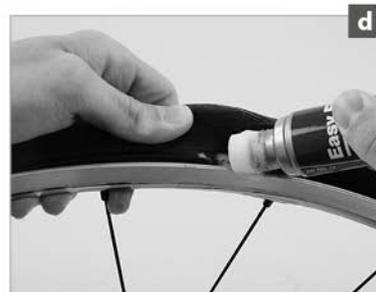
Sitzt der Reifen, prüfen Sie am Kontrollring (g), ob der Reifen gleichmäßig über den gesamten Umfang an beiden Seiten in der Felge liegt. Drehen Sie dazu das Laufrad langsam und beobachten Sie den Verlauf des Kontrollrings zur Oberkante der Felge. Gegebenenfalls müssen Sie etwas Luft ablassen und den Reifen ausrichten.
