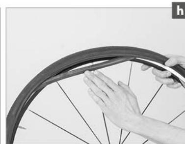
Arbeiten Sie gleichmäßig nach beiden Seiten am Umfang entlang. Zum Ende hin müssen Sie den Reifen kräftig nach unten ziehen (a), damit der schon montierte Bereich in den tiefen Felgenboden rutscht. Dies erleichtert die Montage auf den letzten Zentimetern spürbar.
