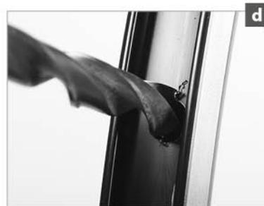
Um mit flüssigem Reifenkitt einen gut haftenden Untergrund zu schaffen, sind mehrere Lagen Klebstoff notwendig. Verteilen Sie den Reifenkitt gleichmäßig und in einer möglichst dünnen Schicht über nahezu den gesamten Umfang der Felge.
