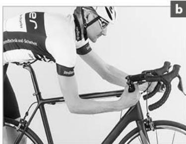
Wenn das Lager Spiel hat, verschiebt sich die obere Schale mit einem leichten Ruck gegenüber der unteren – sichtbar auch am Spalt zwischen den Lagerschalen.
