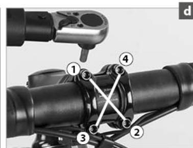
Versuchen Sie, den Lenker gegenüber dem Vorbau zu verdrehen und drehen Sie ggf. die Verschraubung nochmals nach. Benutzen Sie einen Drehmomentschlüssel und überschreiten Sie die maximalen Schraubendrehmomente nicht! Sie finden diese im Kapitel „**Empfohlene Schraubendrehmomente**“, auf den Bauteilen selbst und/oder in den Anleitungen der Komponentenhersteller.
