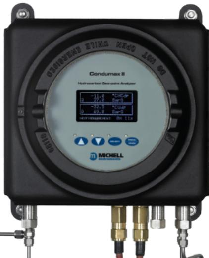
Zur Online Messung der Kohlenwasserstoff-Kondensations-temperatur (auch: KW-Taupunkt oder HCDT) und des Wasser-Taupunkts in Erdgas (auch:  $\text{H}_2\text{O}$ -Taupunkt) wird das patentierte Dark-Spot™ Prinzip, basierend auf fundamentaler Taupunktspiegel-technologie für die hochauflösende, genaue und wiederholbare KW-Taupunktmessung in Erdgas verwendet.
