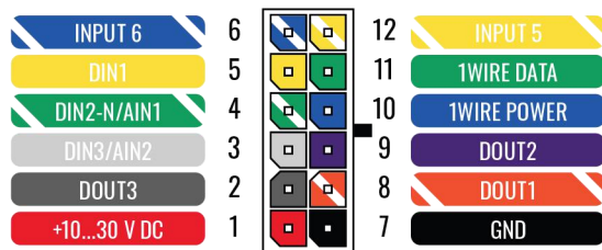
FMC130 2x6 csatlakozó kiosztás
