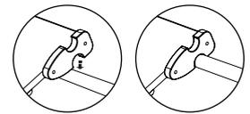
Para garantizar un ensamblaje seguro y estable entre los diferentes elementos Pikler, compruebe que cada gancho de conexión esté bien colocado sobre un peldaño y que no se desplace.
