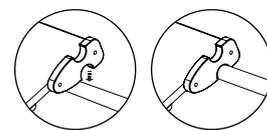
Aby zapewnić bezpieczne i stabilne połączenie pomiędzy oddzielnymi jednostkami Pikler, należy sprawdzić, czy każdy hak łączący jest pewnie zamocowany na szczeblach i nie przesuwa się.
