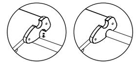
Um eine sichere und stabile Verbindung zwischen den einzelnen Pikler-Geräten zu gewährleisten, stellen Sie sicher, dass jeder Verbindungshaken sicher über einer Sprosse angebracht ist und sich nicht verschiebt.
