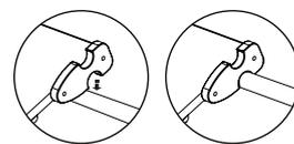
個々のPiklerユニットが安全かつ安定的につながるようするため、各コネクタフックがよじ横桟に確実に固定され、ずれないことを確認してください。
