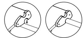
Da bi zagotovili varno in stabilno povezovanje ločenih piklerjevih elementov, preverite, ali je vsak povezovalni kavelj varno nameščen na prečko in se ne premika.
