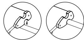
Abyste zajistili bezpečné a stabilní spojení mezi jednotlivými jednotkami systému Pikler, zkontrolujte, zda jsou všechny spojovací háčky bezpečně nasazeny na příčku prolézačky a zda se neposouvají.
