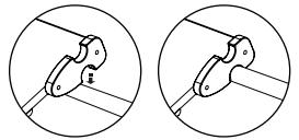
個々のPiklerユニットが安全かつ安定的につながるようにするため、各コネクターフックがよじ登り桟に確実に固定され、ずれないことを確認してください。
