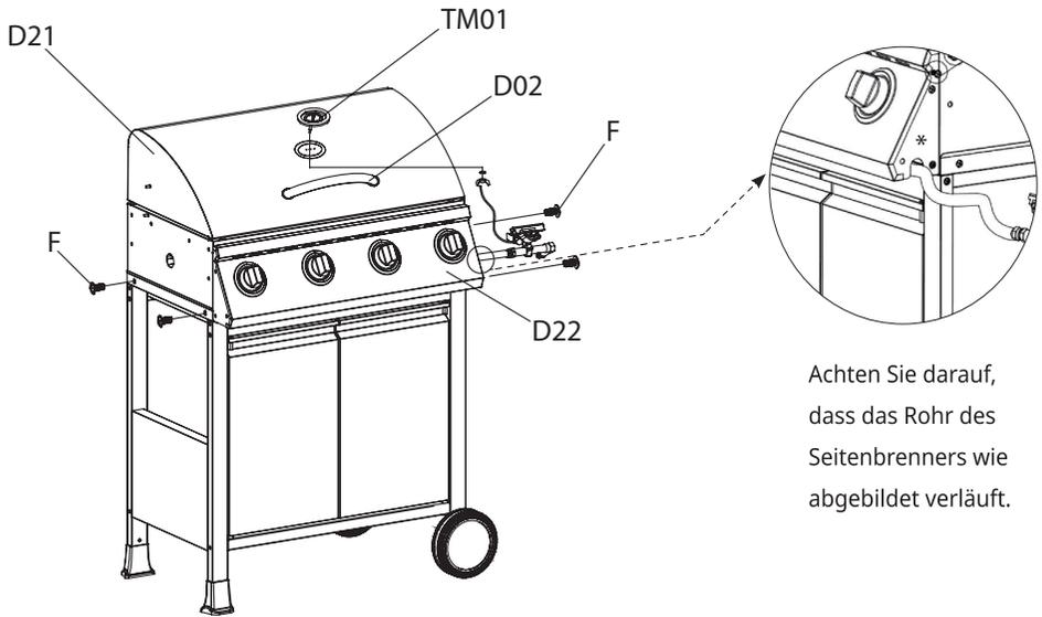
Achten Sie darauf, dass das Rohr des Seitenbrenners wie abgebildet verläuft.
