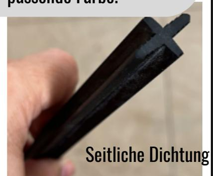
Die **Seitendichtungen** haben ein kreuzförmiges Profil mit einem gerippten Arm, der in die Nut der angrenzenden Steinblöcke passt, und einer nach oben und unten gerichteten 4 mm breiten Rippe, die für einen flexiblen und gedämpften Abstand zwischen den Blöcken sorgt.
