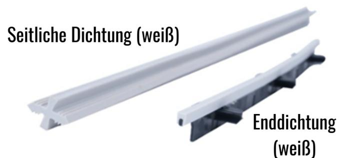
**TIPP:** Zum Einsetzen der Seitendichtung diese durch einen nassen Schwamm ziehen - das Wasser schmiert die Dichtung, so dass sie leichter in die Nut des Steinbodens gleitet.
