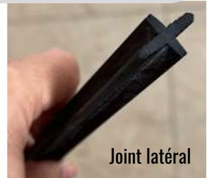
Les joints latéraux se présentent sous la forme d'une croix, avec un bras nervuré qui s'insère dans la rainure des blocs de parquet voisins, et une ailette ascendante et descendante de 4 mm de large qui assure un espacement souple et amortissant entre eux.
