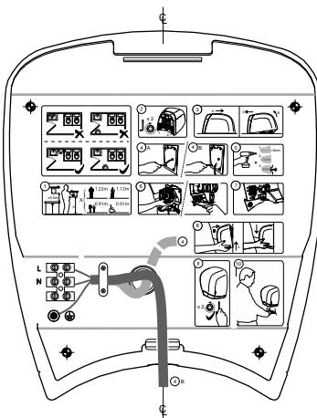
**AVERTISSEMENT : AVANT D'EFFECTUER TOUT RACCORDEMENT ÉLECTRIQUE, COUPER L'ALIMENTATION ÉLECTRIQUE. LE SÈCHE-MAINS / SÈCHE-CHEVEUX DOIT ÊTRE MIS À LA TERRE.**
