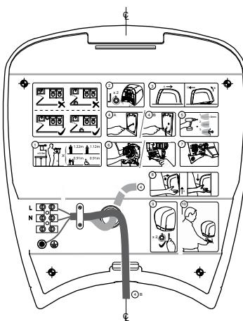
**ADVERTENCIA: DESCONECTAR LA ALIMENTACIÓN DE RED ANTES DE HACER LAS CONEXIONES ELÉCTRICAS. EL SECADOR TIENE QUE ESTAR CONECTADO A TIERRA.**
