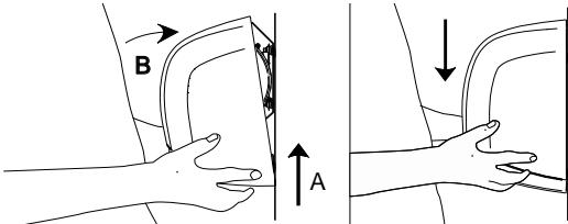
1. Bringen Sie das Gehäuse wieder an, indem Sie das obere Teil des Gehäuses auf Stiftschrauben oben in der Grundplatte positionieren und das Unterteil des Gehäuses in Richtung Wand kippen. Drücken Sie das Unterteil des Gehäuses fest an die Wand.
