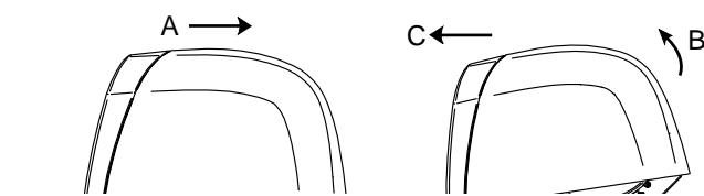
2. 卸除外罩时, 双手放在外罩两边, 向吹干器顶部推 动, 松脱连接外罩与安装基座顶部的固定螺栓, 从 底部向前并向上拉 动, 将 外罩从基座上取下来
