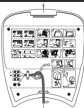
**WARNING: TURN ELECTRICAL POWER SUPPLY OFF BEFORE MAKING ELECTRICAL CONNECTIONS. DRYER MUST BE GROUNDED (EARTHED).**
