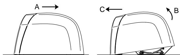
2. Zum Entfernen des Gehäuses halten Sie die Seiten des Gehäuses mit beiden Händen fest und schieben es in Richtung des Oberteils des Trockners, wobei das Gehäuse von den Stiftschrauben oben an der Grundplatte gelöst wird. Heben Sie das Gehäuse von der Grundplatte weg, indem Sie das untere Teil gleichzeitig vorwärts und nach oben ziehen.
