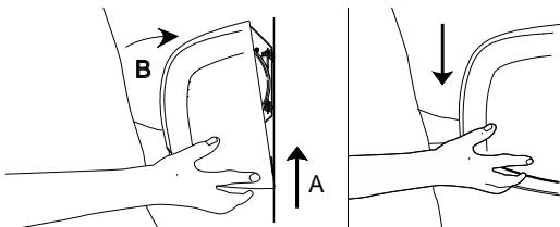
1. Reponer la cubierta colocando la parte superior de la cubierta sobre las clavijas en la parte superior de la base de montaje y girando la parte inferior de la cubierta hacia la pared. Empujar la parte inferior de la cubierta firmemente contra la pared.
