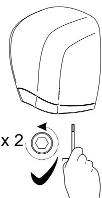
1. 装回外罩时,先将外罩的顶部与安装基座顶部的固定螺栓对齐,再将外罩的底部朝墙壁方向倾斜。用力推压外罩的底部,使其与墙壁贴紧。
