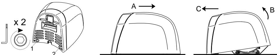
2. Pour retirer le couvercle, placer une main de chaque côté du couvercle, puis le pousser vers le haut de l'appareil afin de dégager le couvercle des languettes situées sur la partie supérieure du socle. Soulever le couvercle du socle, en tirant simultanément le bas vers l'avant et le haut.
