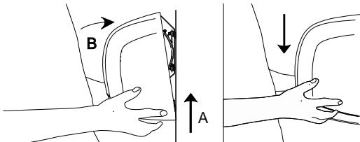
1. Remettre le couvercle en plaçant la partie supérieure du couvercle sur les goujons situés sur le haut du socle, et en inclinant la partie inférieure du couvercle vers le mur. Plaquer fermement la partie inférieure du couvercle contre le mur.
