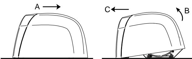
Assicurarsi che la chiave corrisponda alla testa dei bulloni della carcassa e ruotare IN SENSO ORARIO finché i bulloni non smettono di girare. Quando i bulloni della carcassa sono inseriti fino in fondo, la carcassa può essere rimossa.
