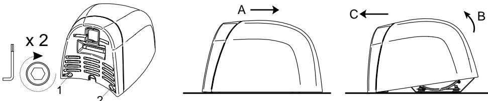
2. Para retirar la cubierta, colocar una mano en cada lado de la cubierta y empujar hacia arriba hacia la parte superior del secador, soltando la cubierta de las clavijas en la parte superior de la base de montaje. Separar la cubierta de la base de montaje tirándola hacia delante y arriba al mismo tiempo.
