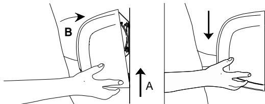
1. Riporre a posto la carcassa posizionando la parte superiore della carcassa sui perni di supporto che si trovano sulla parte superiore della base di montaggio e inclinando il fondo della carcassa verso la parete. Spingere in modo deciso il fondo della carcassa contro la parete.
