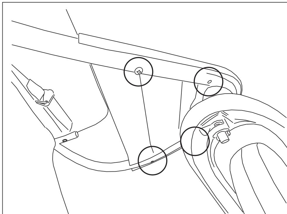
4. Per fissare la pedana: fissare la posizione della pedana al fondo e stringere le viti.
