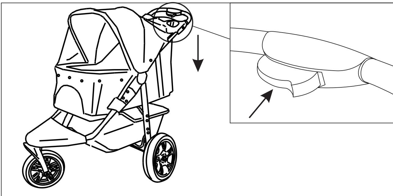
8. plier la poussette : dézipper d'abord la fenêtre de la capote, puis appuyer sur le bouton de pliage dans le sens de la flèche pour plier la poussette et attacher le crochet de pliage.
