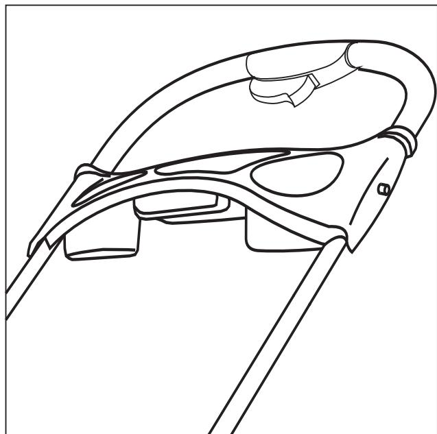
5. pour fixer le porte-gobelet : viser le piquet sur le tube de la poignée et fixer le porte-gobelet.
