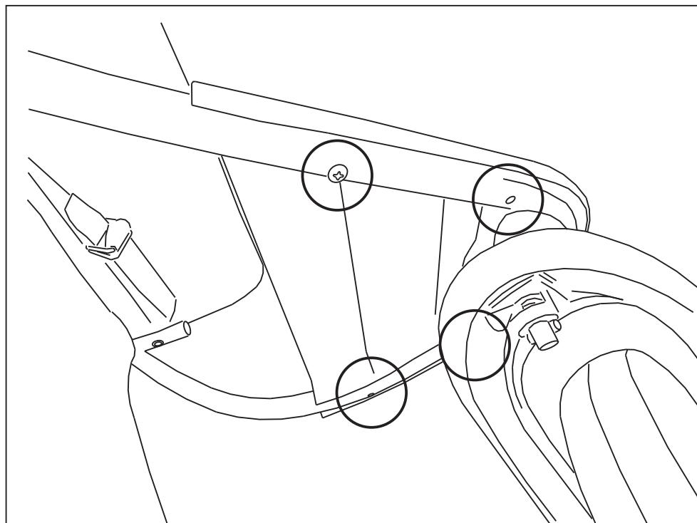
4. zur Befestigung des Trittbretts: Befestigen Sie das Trittbrett am Boden und ziehen Sie die Schrauben fest.
