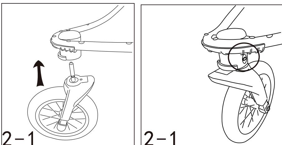
2. Monte la rueda delantera: inserte el eje de la rueda en el orificio HASTA QUE SE OIGA UN "CLIC" como en la imagen 2-1.
