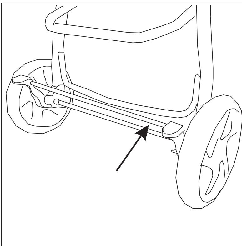
6. Treten Sie die Bremsstange nach unten, um den Kinderwagen anzuhalten, und heben Sie sie an, um die Bremse zu lösen.
