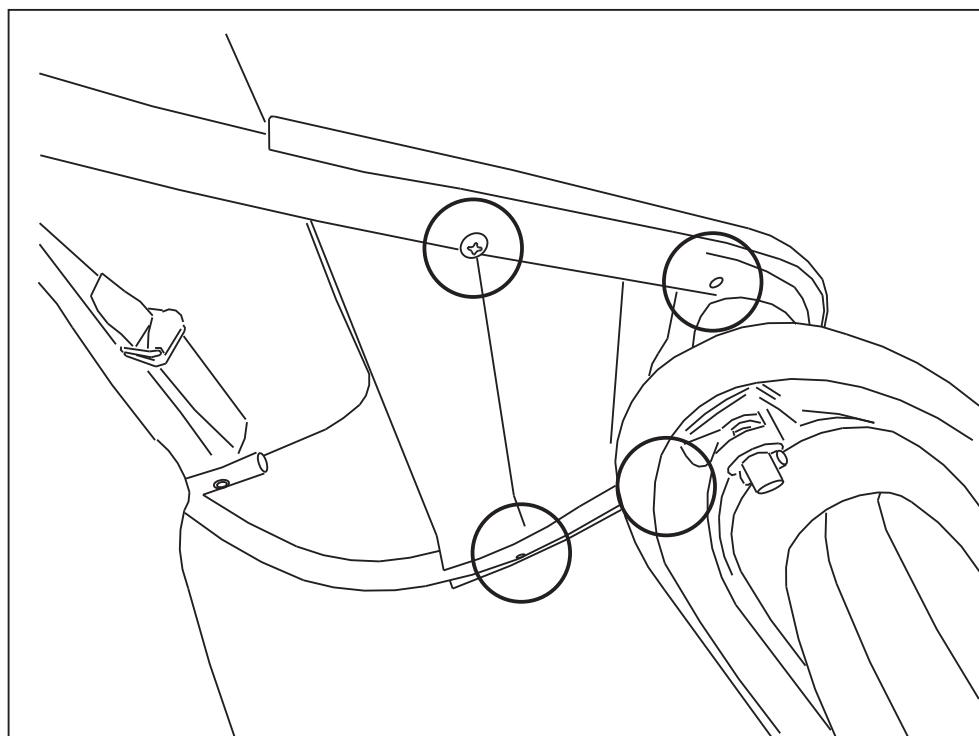
4. Para fijar el estribo: fije la posición del estribo a la parte inferior y apriete los tornillos.
