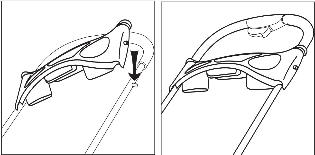
5. zum Anbringen des Becherhalters: zielen Sie auf den Pflock am Griffrohr und befestigen Sie den Becherhalter.
