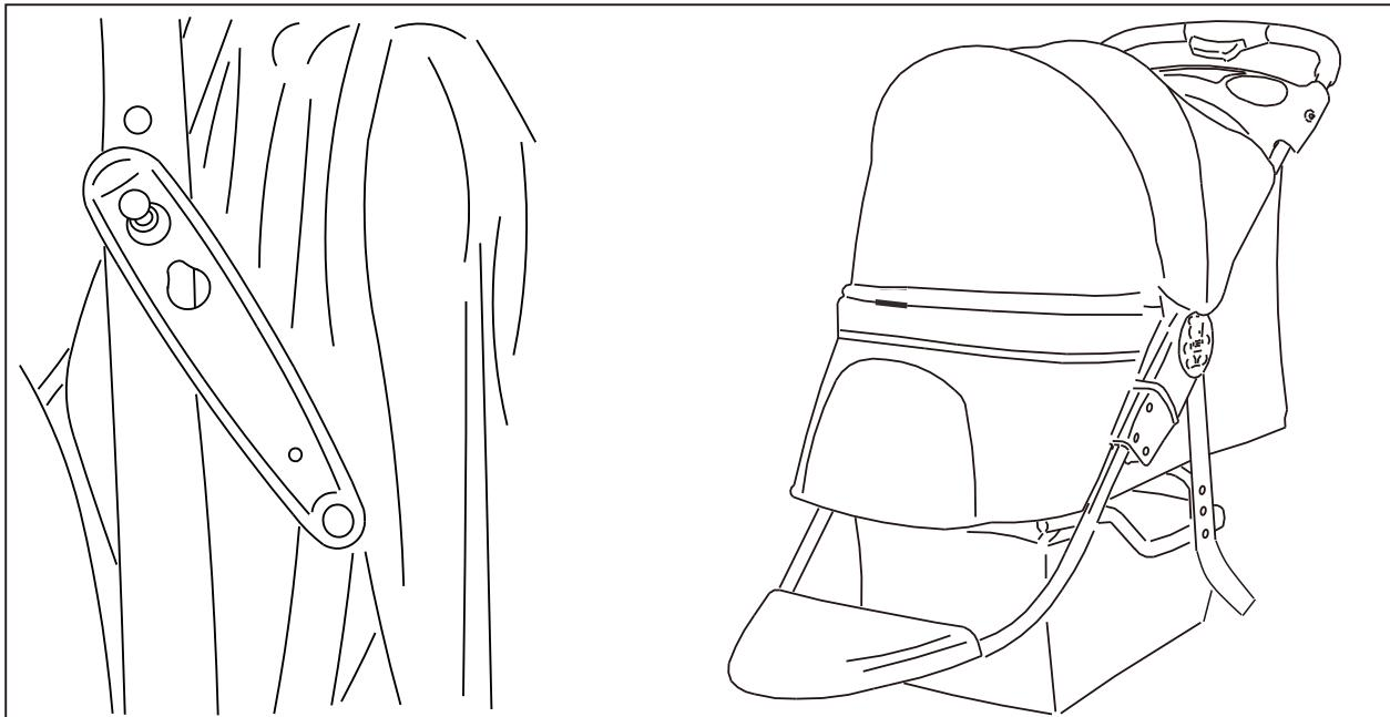
1. pour ouvrir la poussette : détacher le crochet de pliage comme indiqué sur l'image, soulever le guidon, déplier la poussette et s'assurer que les deux articulations sont verrouillées.
