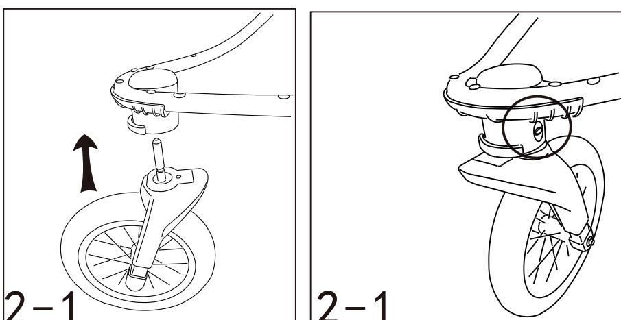
2. monter la roue avant : insérer l'axe de la roue dans le trou jusqu'à ce qu'un "CLIC" se fasse entendre, comme sur l'image 2-1.
