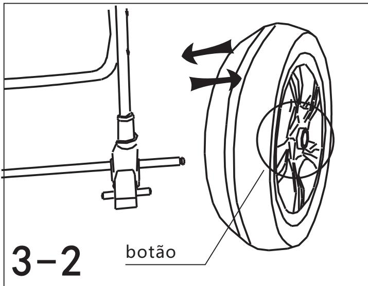
3. Monte a roda traseira: insira a perna do tubo no conector da roda até soar "click" como figura 3-1, e pressione o botão no meio da roda traseira e insira o roda sobre eixo como figura 3-2.
