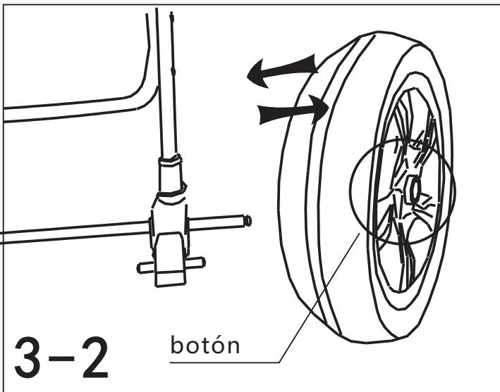
3. Monte la rueda trasera: inserte la pata del tubo en el conector de la rueda hasta que suene un "clic", como se muestra en la figura 3-1, y pulse el botón del centro de la rueda trasera e inserte la rueda en el eje, como se muestra en la figura 3-2.
