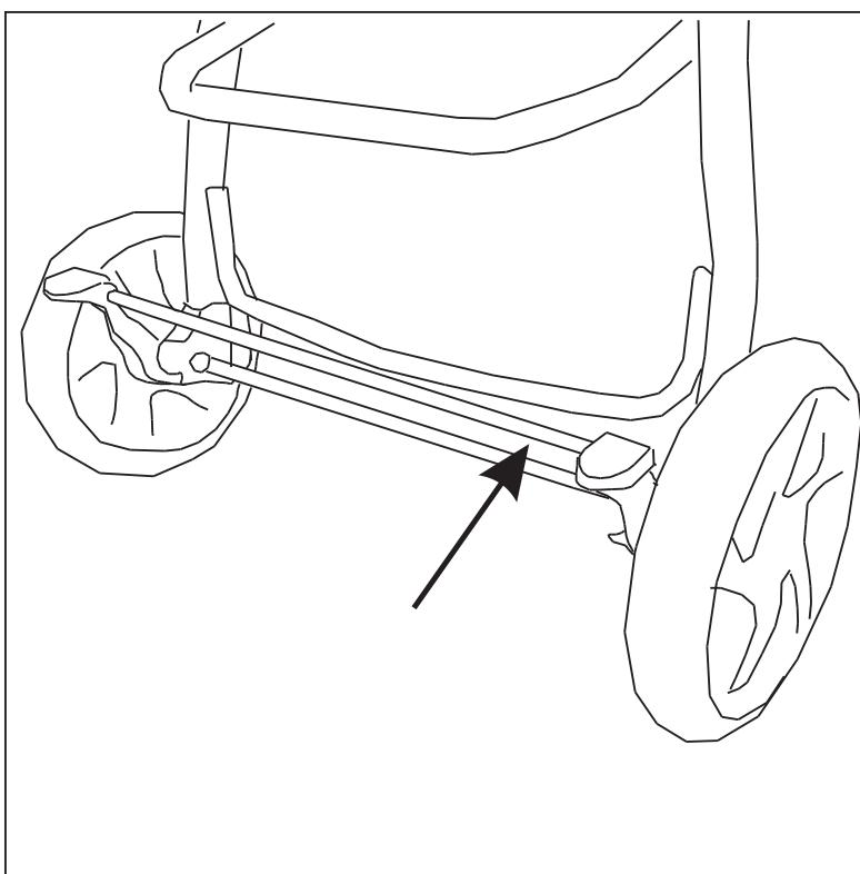
6. Per abbassare l'asta del freno per arrestare il passeggino e sollevarla per rilasciare il freno.
