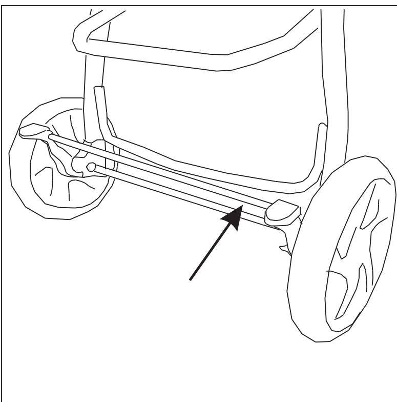
6. Para pisar el freno, baje la barra para detener el cochecito y levántela para soltar el freno.
