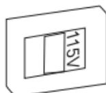
En la parte trasera encontrarás un interruptor para seleccionar el voltaje de la fuente de poder (115 Vc.a. – 220 Vc.a.).
