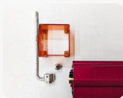
Rimuovere il coperchio protettivo, il coperchio della guida dell'aria, l'ugello e lo specchio retrovisore.
