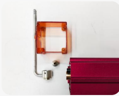
Retire la cubierta protectora, la cubierta de la guía de aire, la boquilla y el espejo de la ventana.
