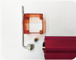
Retirez le couvercle de protection, le couvercle du guide d'air, la buse et le rétroviseur.
