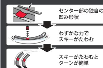
ベンデックステクノロジーは誰でも簡単にターンが楽しめるように考えられたテクノロジーです。スキーセンター部分は凹(くぼみ)形状にすることで雪面に接触しやすく、少ないパワーで簡単にターンをすることができます。
