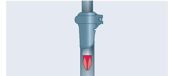
クリス・ベンチェラーのアイデアから生まれたスキー場でも簡単にビンディング微調整を行える。+、-のスクリュードライバーをポールに内蔵。(9mmフィリップ社製)
