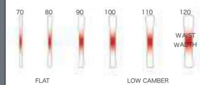
各サイズ毎にウエスト幅、キャンパーV字形状、成長過程に合わせたサイドカットを採用しています。
