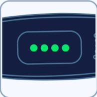
**5.4.** Wenn der Vorgang erfolgreich abgeschlossen wurde, leuchten die LEDs kurz grün auf. Lassen Sie das Gerät bis zum Ende des Einrichtungs-vorgangs in der Ladeschale.
