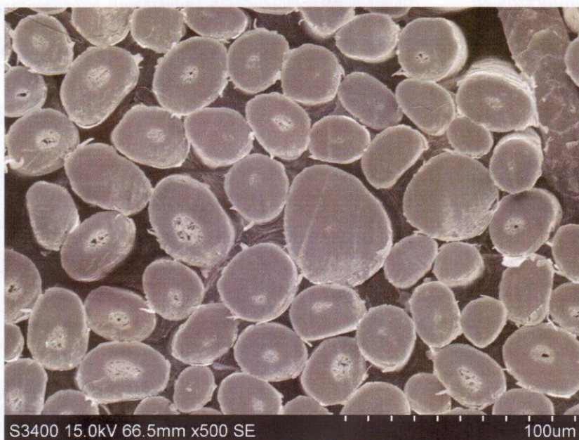
Rysunek 4. Mikrofotografia przekroju poprzecznego włókien pochodzących z czesanki, powiększenie 500 razy.
