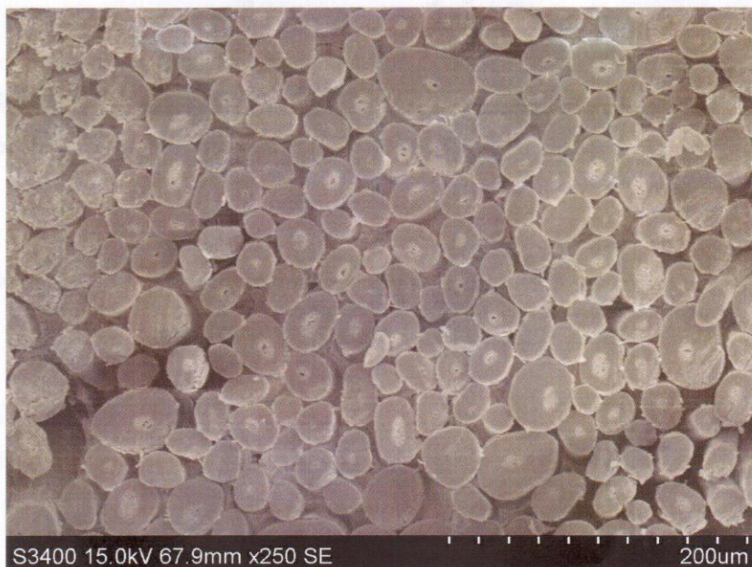
Rysunek 3. Mikrofotografia przekroju poprzecznego włókien pochodzących z czesanki, powiększenie 250 razy.
