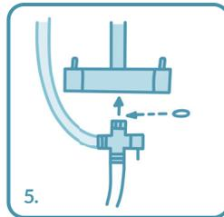
Dichtring in die obere Öffnung einsetzen und 3-Wege Adapter wieder an die Armatur schrauben.
