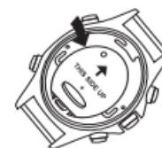
6. Riporre il retrocoperchio assicurandosi che la batteria sia stata montata correttamente, che la tenuta di gomma attorno al retrocoperchio sia assestato correttamente, che il retrocoperchio sia montato senza interferenze e nel verso corretto. Se possibile aggiungere del grasso di silicone o della vaselina sulla tenuta di gomma.
