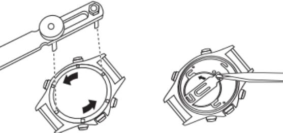
2. Il y a une étiquette de protection sur la pile. Elle est nécessaire pour l'isolation et doit être remise en place lorsque la nouvelle pile a été installée.
