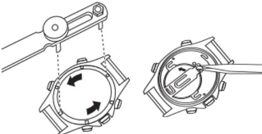
2. Sulla batteria vi è un'apposita etichetta di protezione. Questa si richiede per scopi d'isolamento e deve essere rimessa quando la batteria è stata montata.
