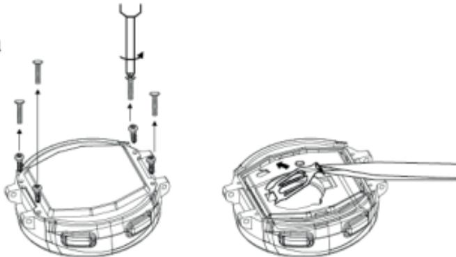
2. Sulla batteria vi è un'apposita etichetta di protezione. Questa si richiede per scopi d'isolamento e deve essere rimessa quando la batteria è stata montata.
