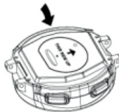
6. Riporre il retrocoperchio assicurandosi che la batteria sia stata montata correttamente, che la tenuta di gomma attorno al retrocoperchio sia assestato correttamente, che il retrocoperchio sia montato senza interferenze e nel verso corretto. Se possibile aggiungere del grasso di silicone o della vaselina sulla tenuta di gomma.
