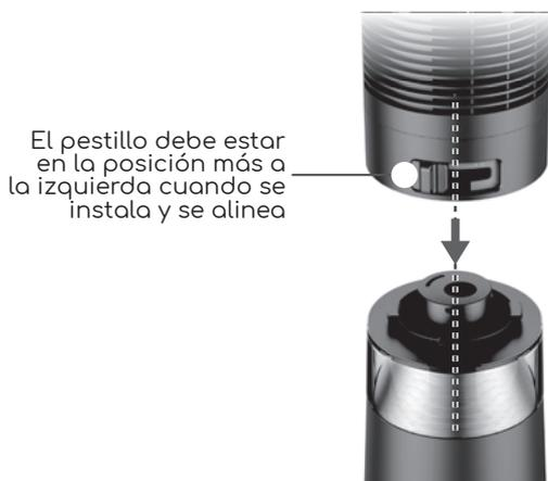
3. Una vez alineado correctamente el cuerpo, gire el pestillo del lado izquierdo al derecho. La máquina estará lista para su uso cuando se oiga un pitido tras 1 segundo de encendido
