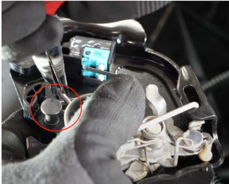
Abbildung 15: Feder der Schlosseinheit
