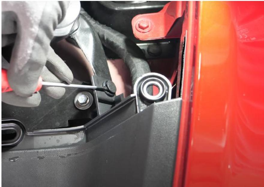
Abbildung 3: Lösen der Stiftklemme
