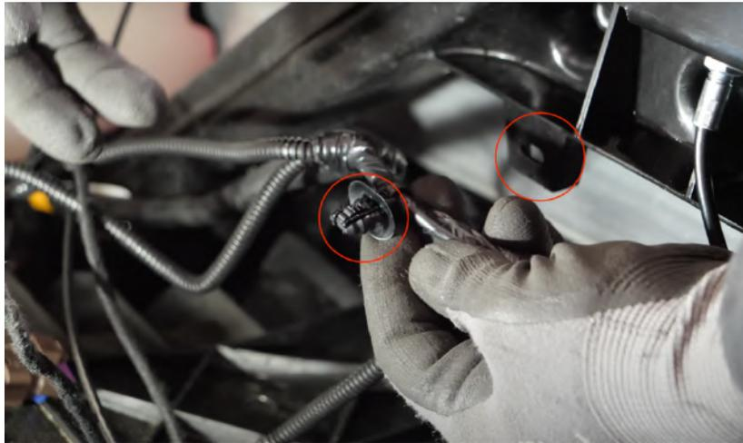
Abbildung 22: Lösen des Kabelbinders
