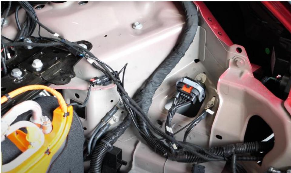
Abbildung 41: Kabelführung und Kabelfixierung
