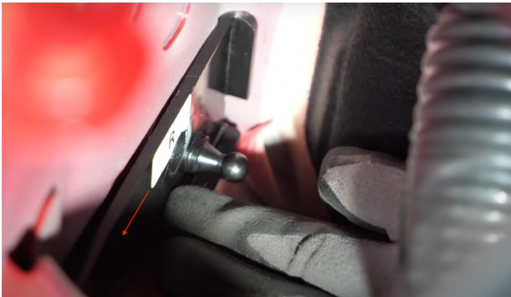
Abbildung 12: Anbringung Adapterplatte
