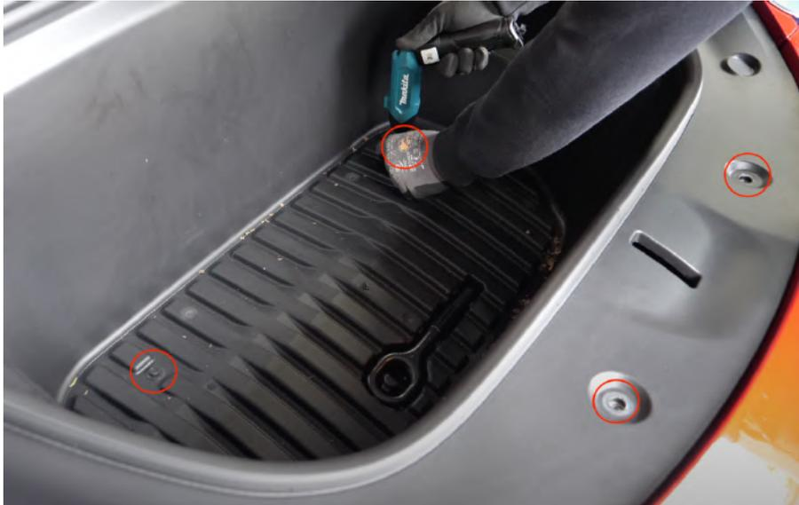
Abbildung 2: Schrauben der Plastikwanne
