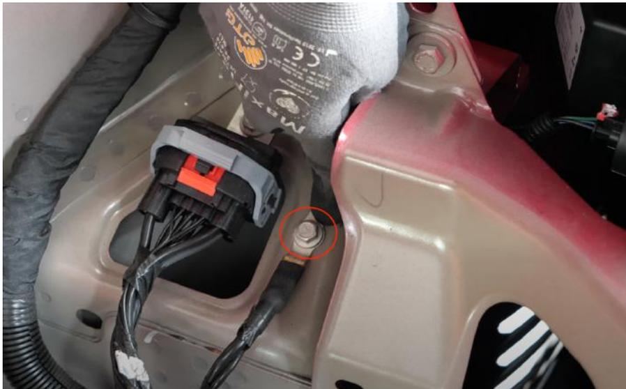
Abbildung 39: Schraube zum Abgreifen der Masse
