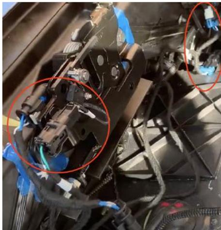
Abbildung 32: Steckerverbindung des Schlosssignals, Mikrotasters (links im Bild) und Schlosstroms (rechts im Bild)
