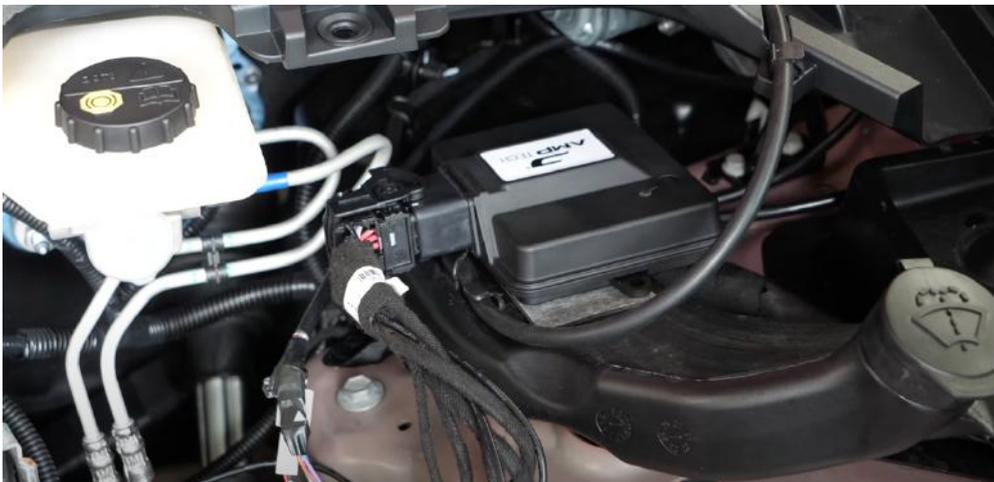
Abbildung 27: Anbringung der Steuereinheit
