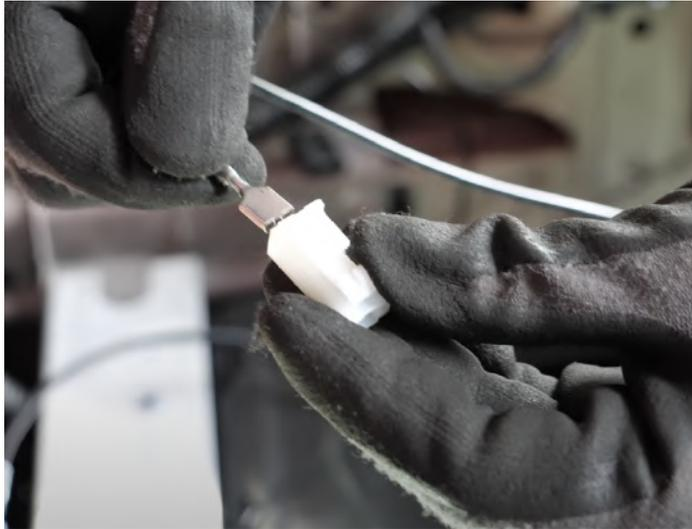
Abbildung 40: Einschub der Flachsteckhülse
