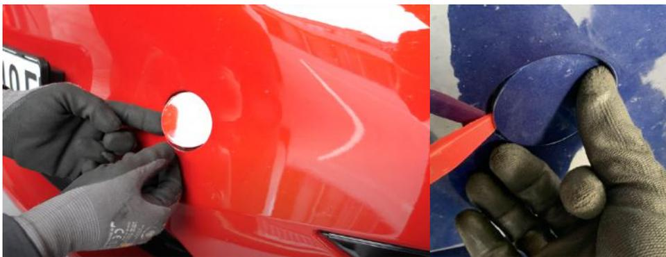
Abbildung 24: Lösen der Abschleppkappe
