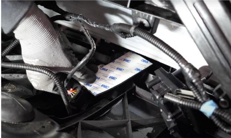
Abbildung 23: Alternative Befestigung des Softclose Motors
