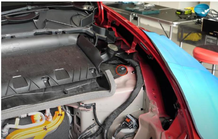
Abbildung 5: Verschraubung des Filters
