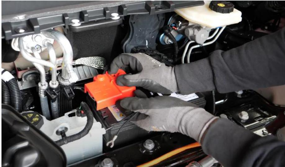
Abbildung 37: Entfernen der Batteriekappe
