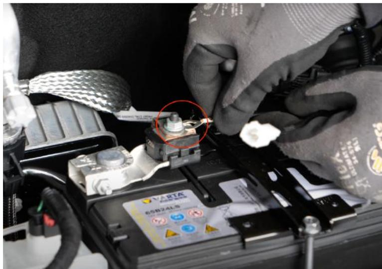
Abbildung 38: Stromadapterkabel am positiven Pol der Batterie
