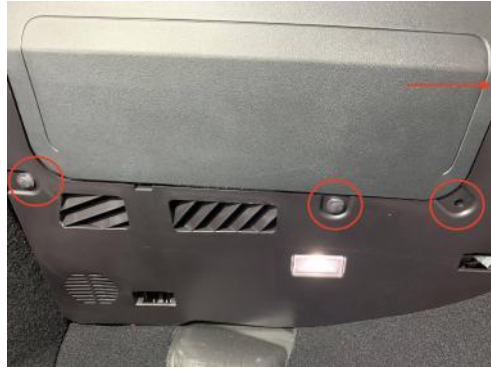
Abbildung 15: Befestigungen der Verkleidung unterhalb des Handschuhfachs
