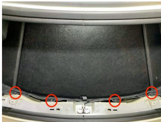
Abbildung 4: Befestigungsklemmen an der Unterseite der Kofferraumöffnung
