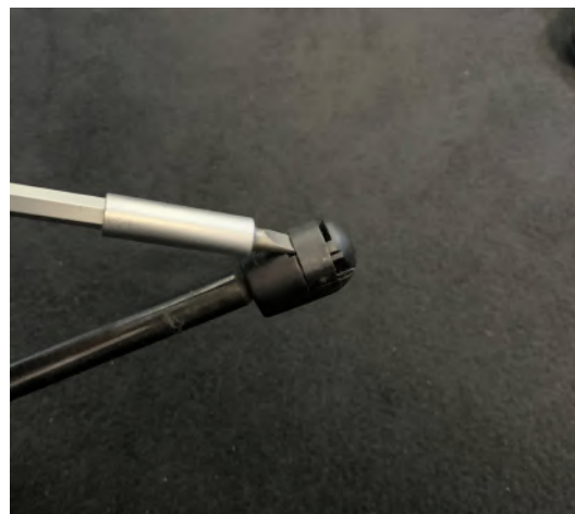
Abbildung 3: Ansatzpunkt für das Lösen des Sicherungssplints
