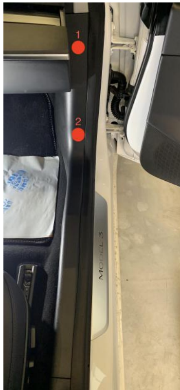
Abbildung 16: Zu entfernende Plastikverkleidungen
