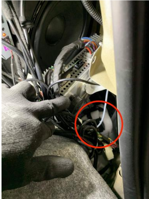
Abbildung 14: Positionierung des Softclose Motor
