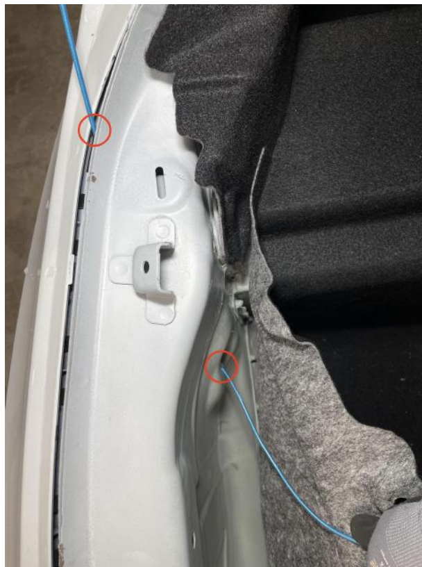
Abbildung 6: Durchführung der Einziehhilfe auf der linken Fahrzeugseite
