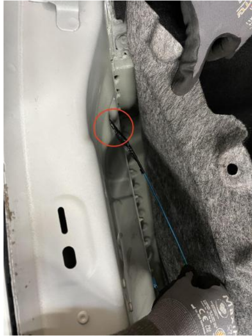
Abbildung 8: Durchführen der Hubarmkabel
