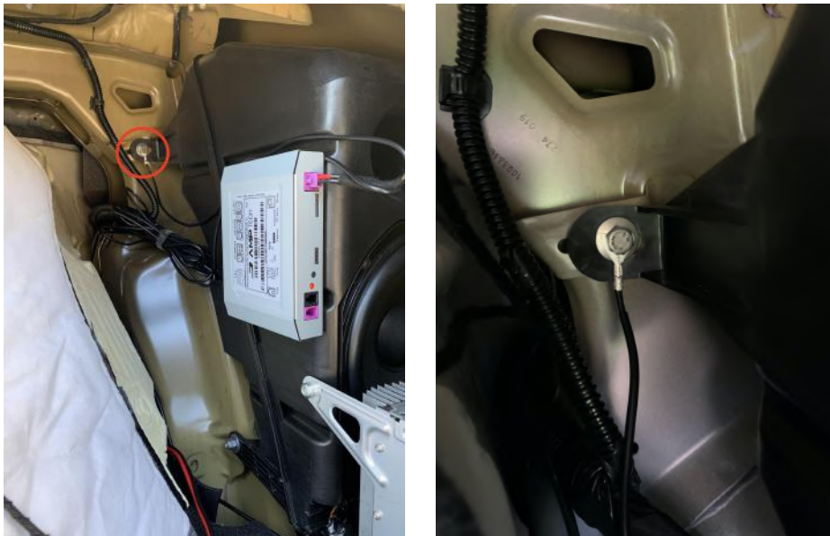
Abbildung 25: Schraube für das Abgreifen der Masse
