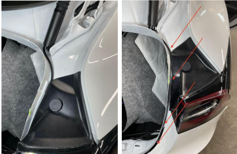
Abbildung 5: Hubarmkabel entlang der Kontur
