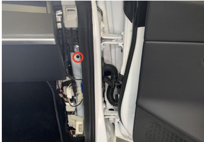
Abbildung 17: Befestigungsklemme seitlich des Armaturenbretts
