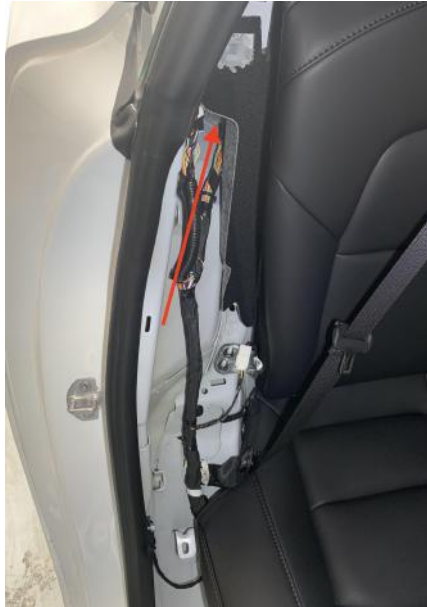
Abbildung 24: Durchführung des Massekabels
