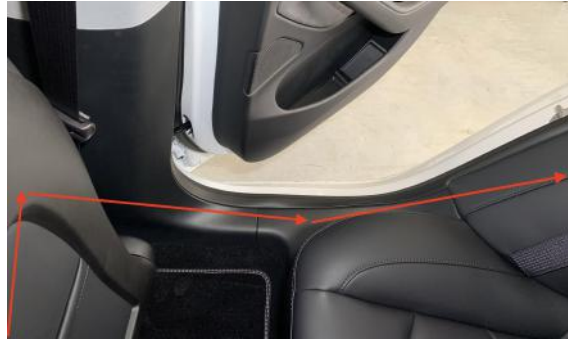
Abbildung 27: Führung des CAN-Verlängerungskabels
