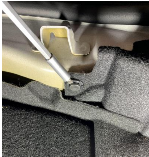
Abbildung 2: Ansatzpunkt zum Lösen der Befestigungsklemme
