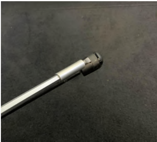
Abbildung 3: Ansatzpunkt für das Lösen des Sicherungssplints
