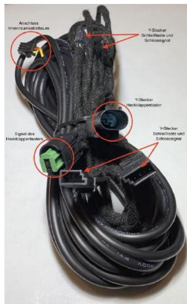
Abbildung 1: Heckklappenkabelbaum
