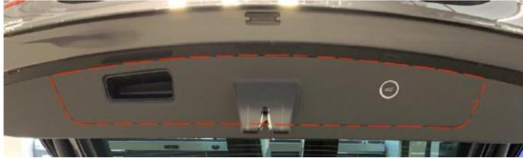
Abbildung 2: Plastikverkleidung um das Heckklappenschloss
