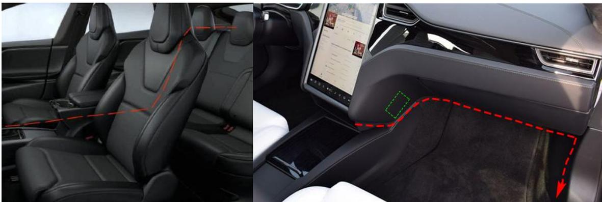
Abbildung 8: Kabelführung durch den Innenraum
