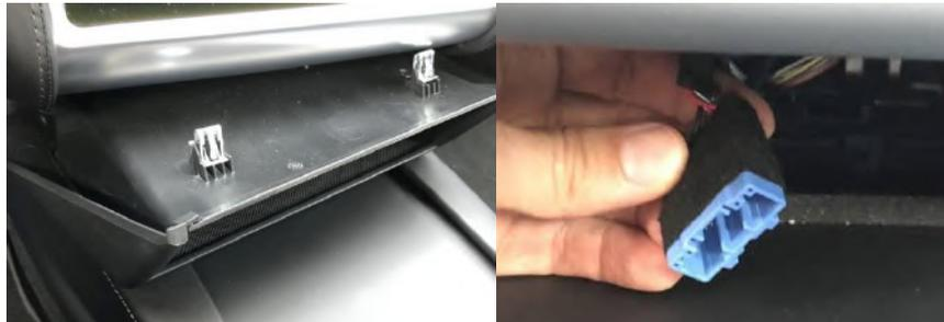
Abbildung 9: Ablagefach und Diagnoseanschluss
