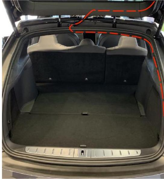
Abbildung 6: Führung des Heckklappenkabelbaums
