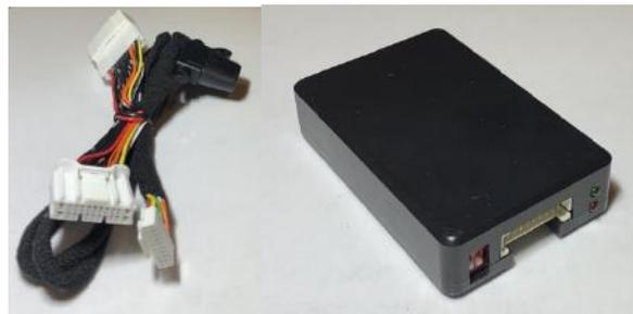
Abbildung 10: Splitter-Kabelbaum und Steuereinheit
