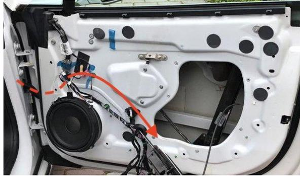
anschließend durch die im oberen Bild gezeigte Öffnung zum schwarzen Stecker der Türschlosseinheit geführt werden.
