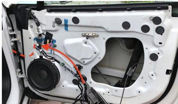
**Achtung:** Es wird empfohlen bei diesem Schritt eine Einziehhilfe und Kabelschmiermittel zu verwenden, um die bereits im Kabelschlauch vorhandenen Kabel nicht zu beschädigen. Die Lautsprecheröffnung dient bei diesem Schritt als Zugang.
