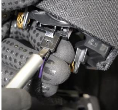
Abbildung 2: Lösen des Widerhakens
