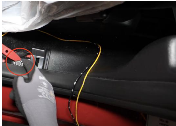
Abbildung 38: Stiftklemme der B-Säulenverkleidung
