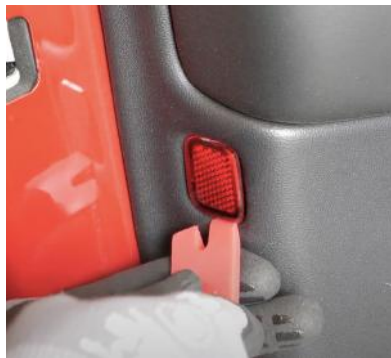
Abbildung 3: Entfernen des Reflektors
