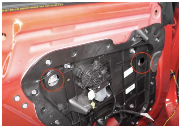
Abbildung 42: Schrauben der Fensterfassung
