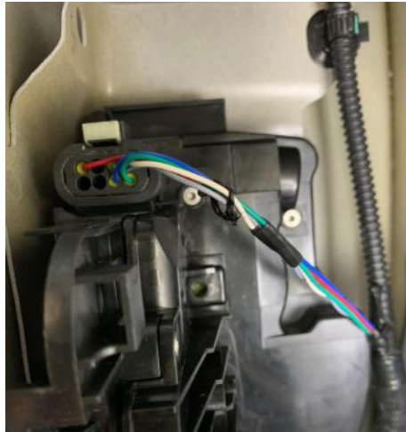
Abbildung 26: Oberer Anschluss der Schlosseinheit
