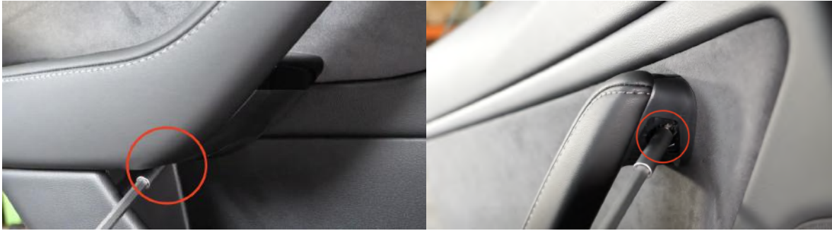
Abbildung 41: Zu entfernende Schrauben der hinteren Türverkleidung
