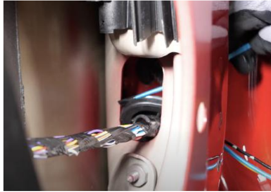
Abbildung 36: Durchführung von Strom- und Massekabel
