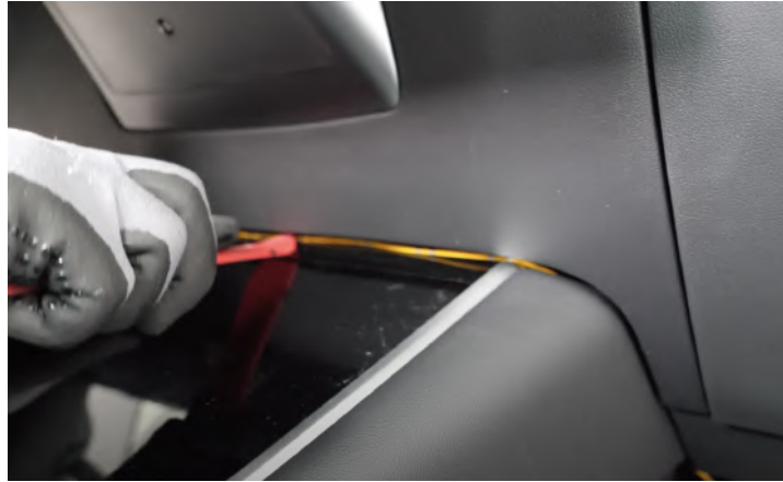
Abbildung 39: Führung des Stromkabels auf die rechte Fahrzeugseite
