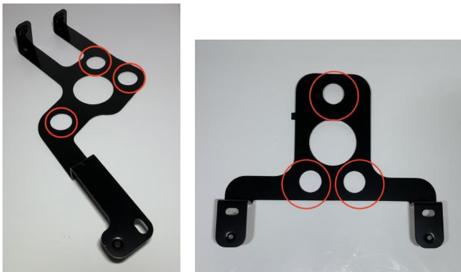
Abbildung 22: Befestigungsschiene Vordertür (links), Hintertür (rechts)
