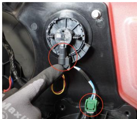
Abbildung 11: Zu entfernende Steckverbindungen
