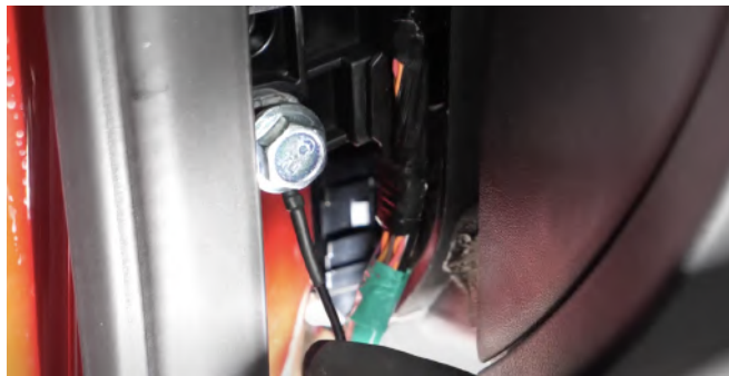
Abbildung 35: Schraube zum Abgreifen der Masse
