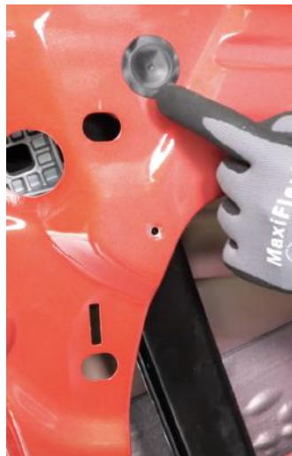
Abbildung 15: Zu entfernende Gummidichtung
