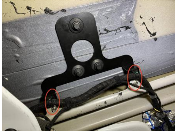
Abbildung 45: Anbringung der Schiene an der hinteren Tür
