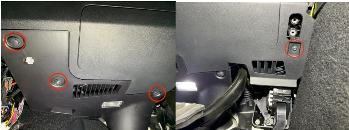
Abbildung 28: Befestigungen der Fußraumverkleidung
