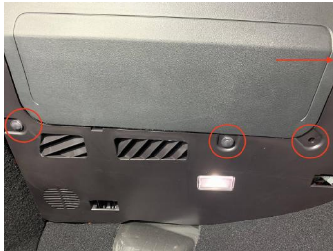
Abbildung 40: Befestigungen des Beifahrerfußraumes
