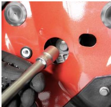
Abbildung 9: Entfernen der Schrauben in der Fensterfassung
