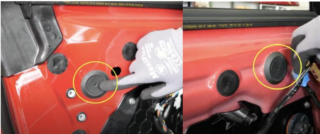
Abbildung 8: Gummidichtungen
