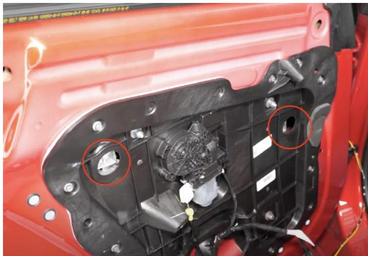
Abbildung 42: Schrauben der Fensterfassung
