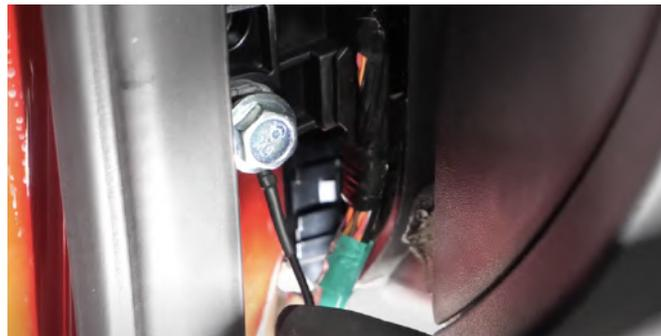
Abbildung 35: Schraube zum Abgreifen der Masse
