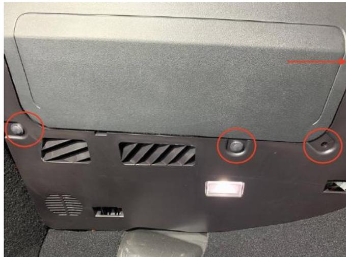
Abbildung 40: Befestigungen des Beifahrerfußraumes
