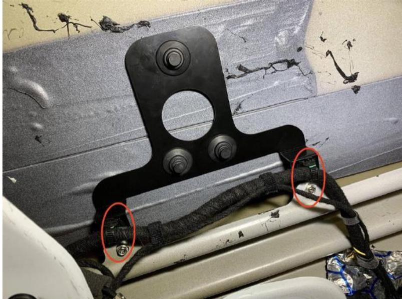
Abbildung 45: Anbringung der Schiene an der hinteren Tür
