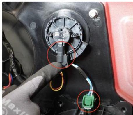
Abbildung 11: Zu entfernende Steckverbindungen
