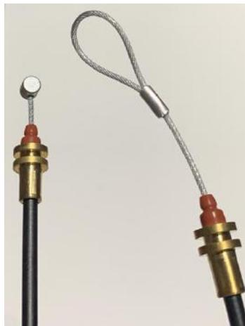
Abbildung 17: Bowdenzugkopf (links) und Bowdenzuglasche (rechts)
