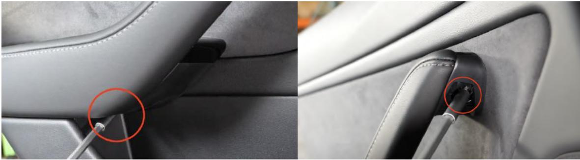
Abbildung 41: Zu entfernende Schrauben der hinteren Türverkleidung
