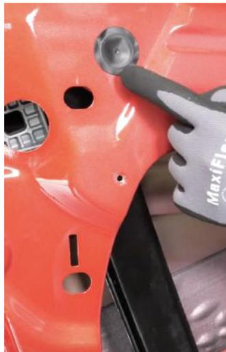
Abbildung 15: Zu entfernende Gummidichtung
