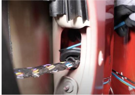
Abbildung 36: Durchführung von Strom- und Massekabel
