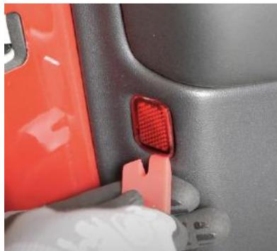
Abbildung 3: Entfernen des Reflektors
