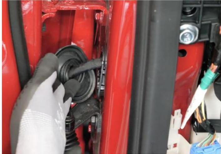
Abbildung 32: Lösen des Kabelschlauchs
