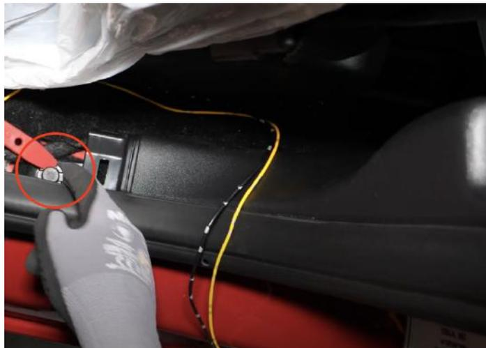
Abbildung 38: Stiftklemme der B-Säulenverkleidung
