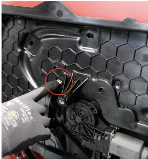
Abbildung 13: Sicherungsklemme
