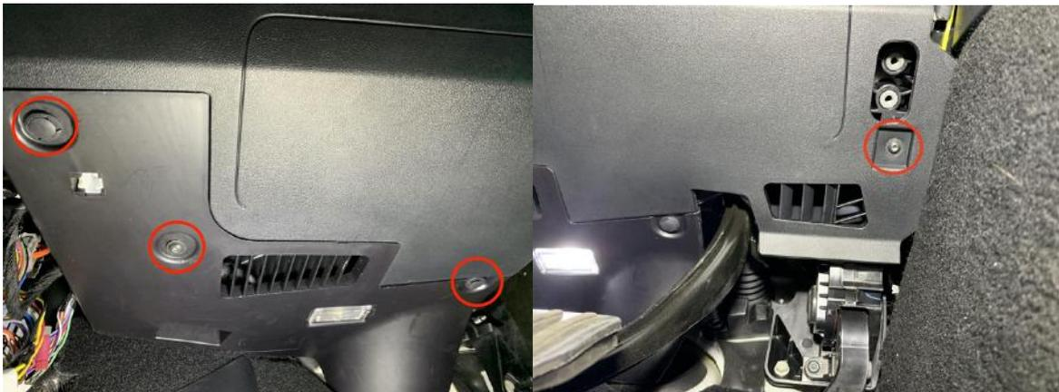
Abbildung 28: Befestigungen der Fußraumverkleidung
