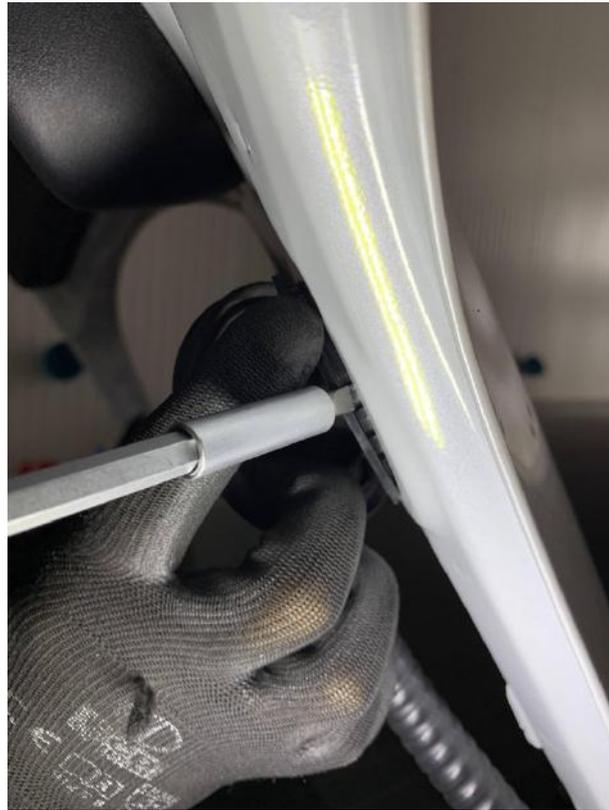
Abbildung 22: Lösen der Plastikhaken
