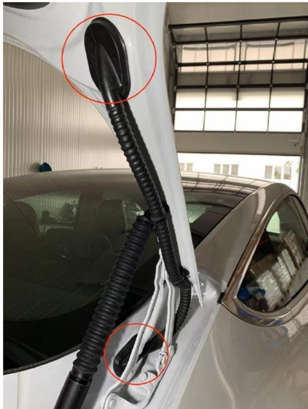
Abbildung 7: Oberes und unteres Ende des Kabelschlauchs
