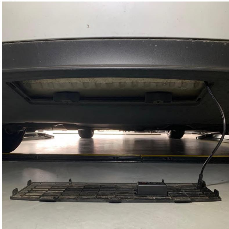
Abbildung 15: Anbringung des Fußsensors
