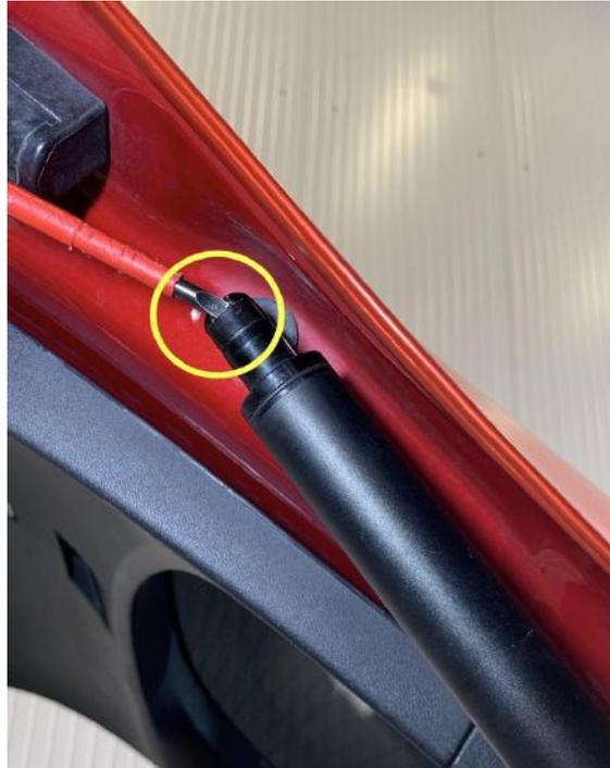
Abbildung 6: Hebeln des Sicherungsplints
