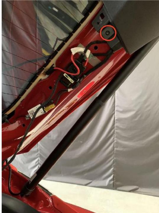
Abbildung 2: Torxschraube unterhalb der Heckklappenverkleidung
