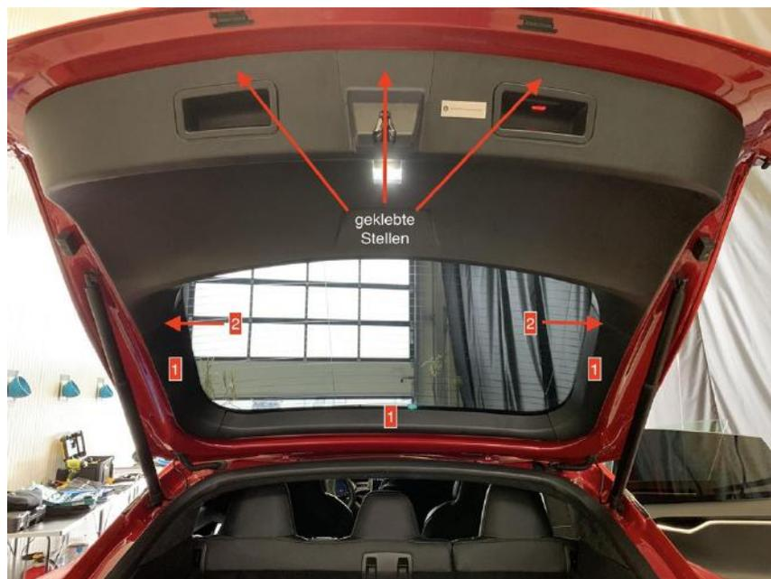
Abbildung 1: Aufbau der Heckklappe
