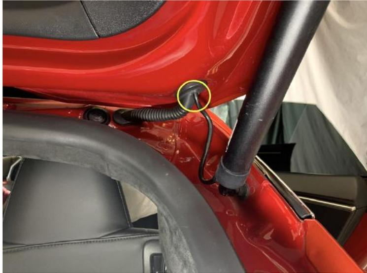
Abbildung 5: Durchführung des Hubarmkabels
