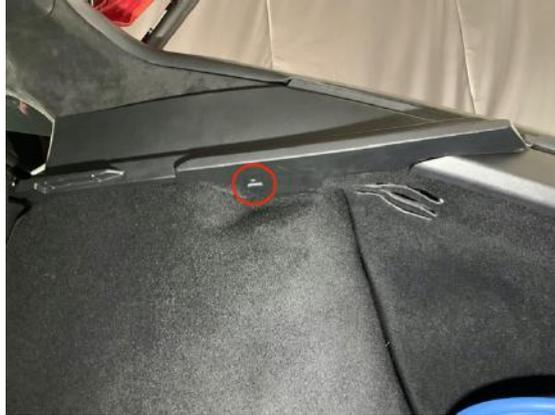
Abbildung 4: Zu lösende Schrauben der Seitenverkleidung
