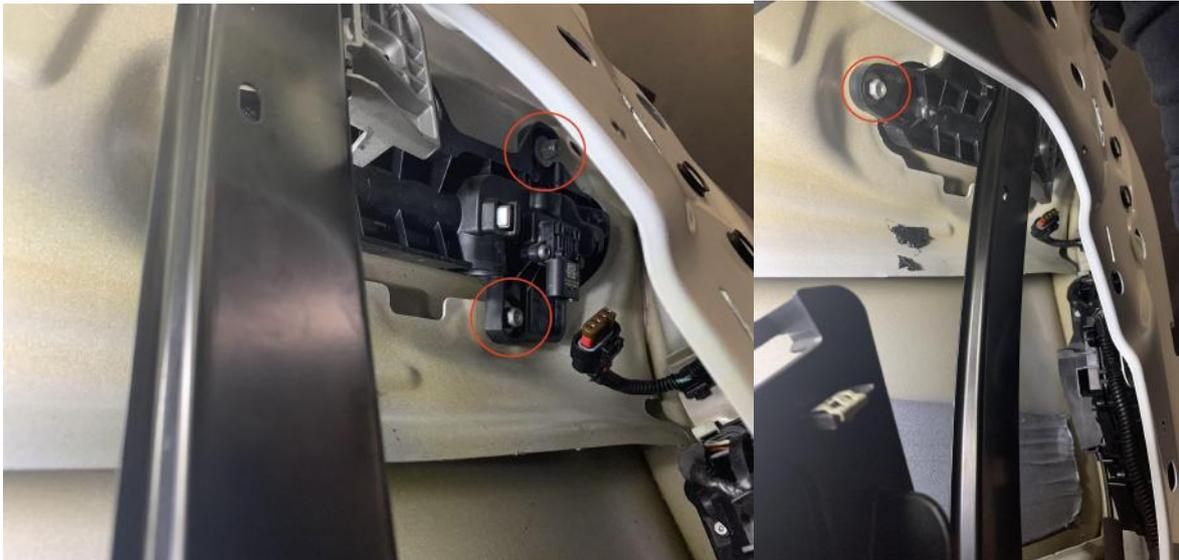
Abbildung 19: Zu lösende Muttern der Türgriffhalterung
