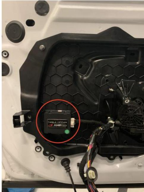
Abbildung 60: Befestigung des Decoders an der Vordertür
