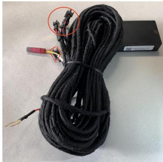
Abbildung 57: Anschlüsse des CAN-Steckers
