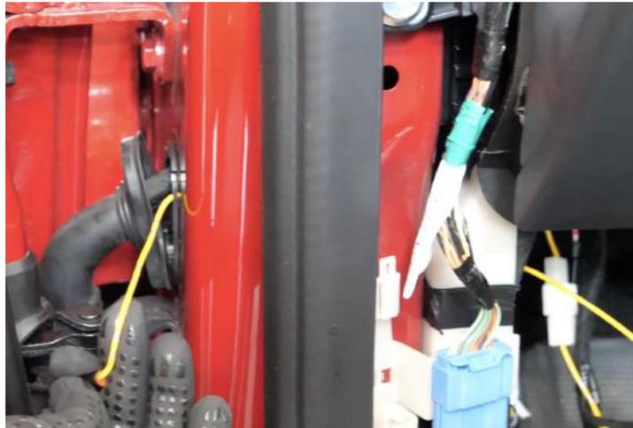
Abbildung 40: Durchführung des Stromkabels
