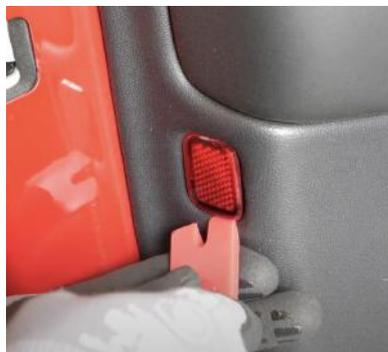
Abbildung 3: Entfernen des Reflektors
