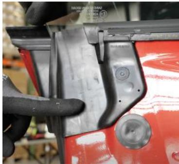
Abbildung 13: Fensterdichtung (Fahrertür)
