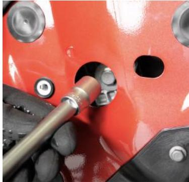
Abbildung 14: Entfernen der Schrauben in der Fensterfassung
