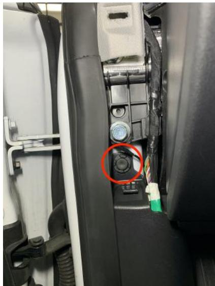
Abbildung 35: Sicherungsklemme
