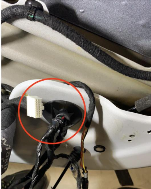
Abbildung 52: Durchführung des Kabels der Steuereinheit
