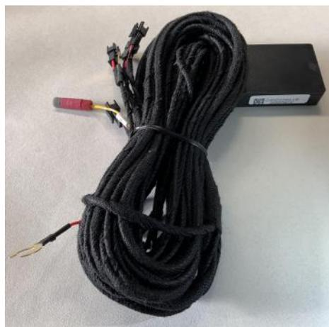
Abbildung 53: CAN-Kabelbaum mit Decoder
