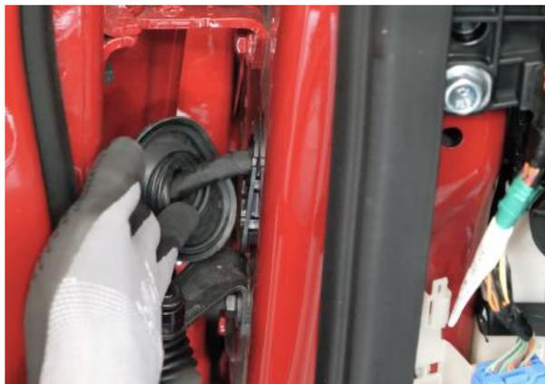
Abbildung 39: Lösen des Kabelschlauchs
