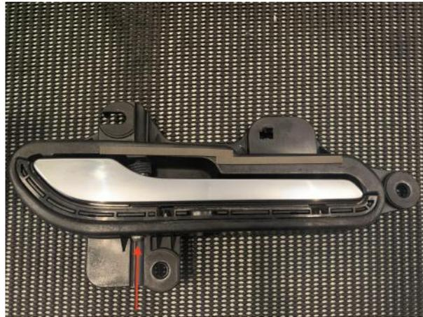
Abbildung 23: Krafttrichtung zum Entfernen des Zentrierungstifts
