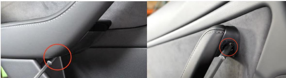
Abbildung 48: Zu entfernende Schrauben der hinteren Türverkleidung
