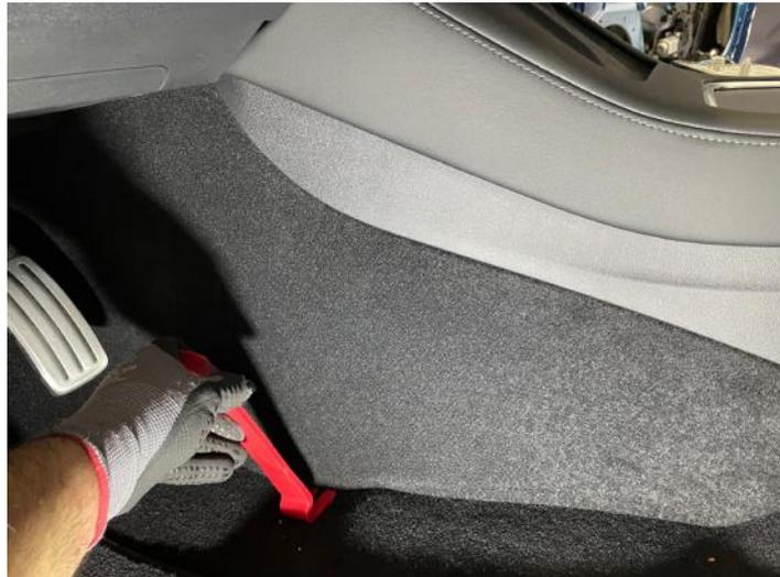
Abbildung 46: Führung des Stromkabels auf die rechte Fahrzeugseite
