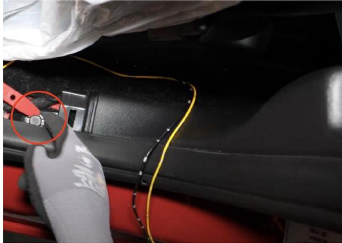
Abbildung 45: Stiftklemme der B-Säulenverkleidung
