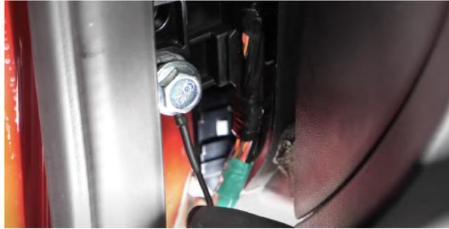
Abbildung 42: Schraube zum Abgreifen der Masse
