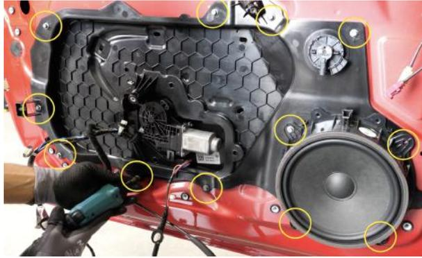
Abbildung 17: Zu entfernende Schrauben der Plastikverkleidung
