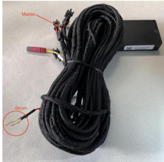
Abbildung 56: Strom- und Masseanschluss
