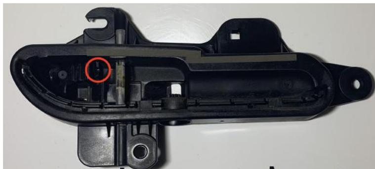
Abbildung 29: Haltevorrichtung der Türgriffhalterung für die Feder
