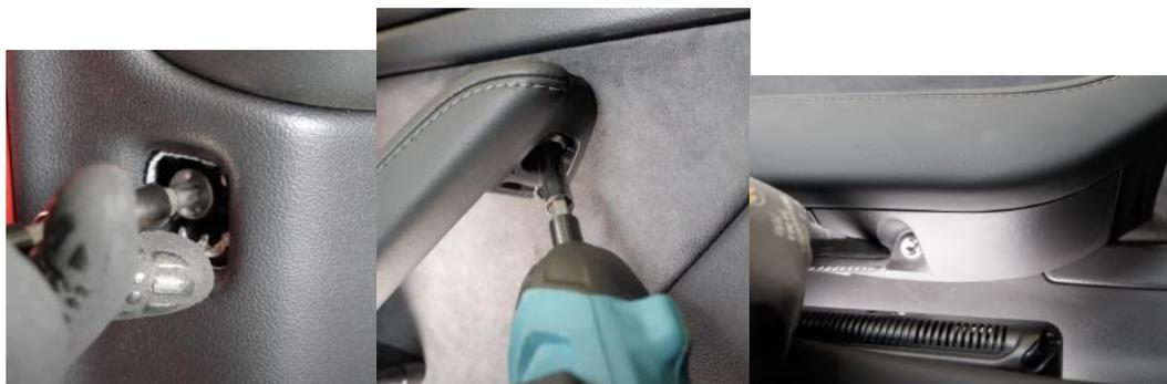
Abbildung 4 (links), Abbildung 5 (Mitte), Abbildung 6 (rechts): Zu entfernende Schrauben der Türverkleidung
