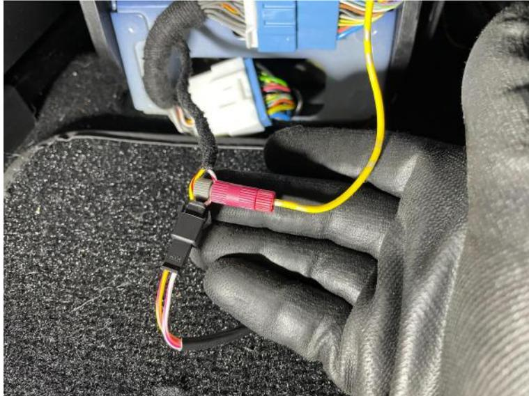
Abbildung 55: CAN-H Kabel der Kofferraumautomatik
