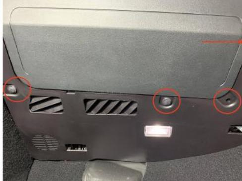
Abbildung 58: Befestigungen der Verkleidung im Beifahrerfußraum
