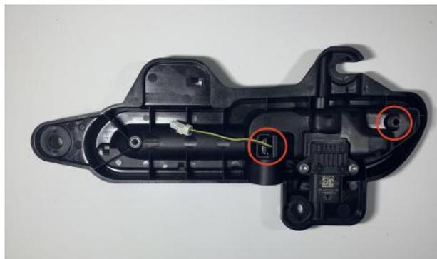
Abbildung 23: Entfernen des Gummistopfens und Kabelführung
