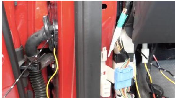
Abbildung 43: Durchführung des Massekabels
