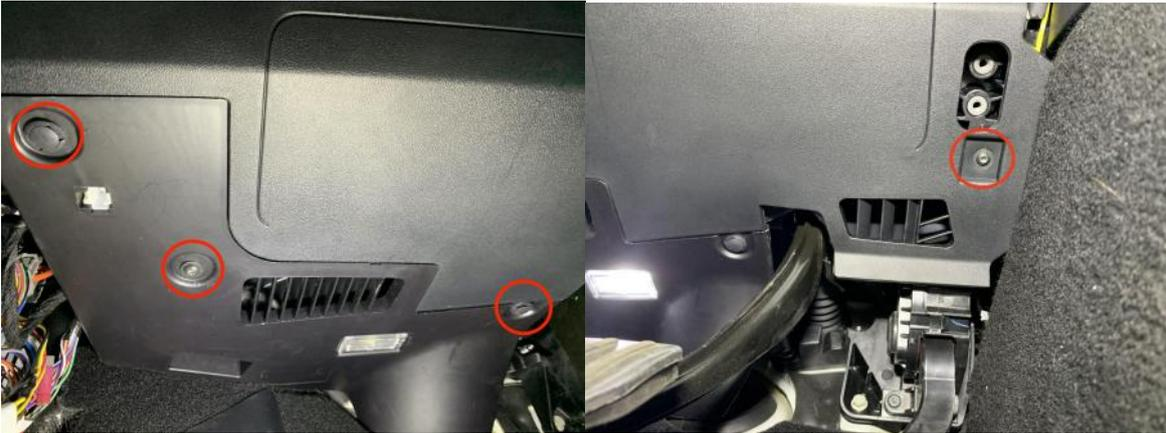
Abbildung 36: Befestigungen der Fußraumverkleidung
