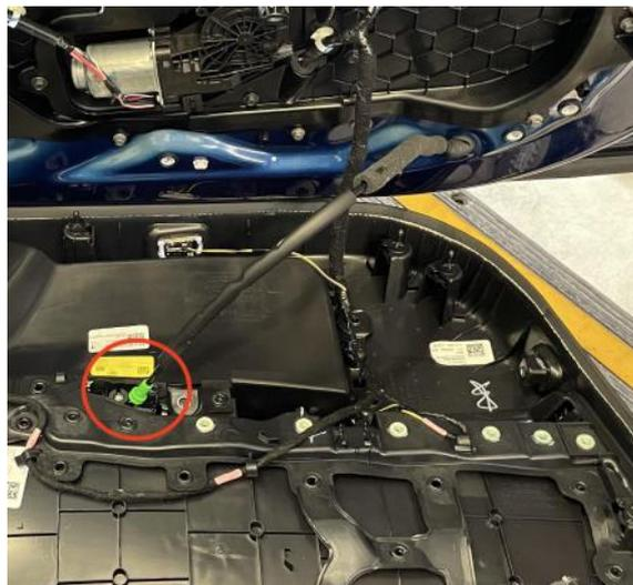
Abbildung 7: Haltevorrichtung des Bowdenzugs
