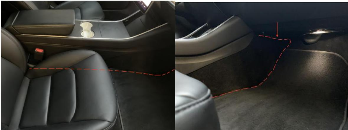
Abbildung 59: Kabelführung des CAN-Kabelbaums
