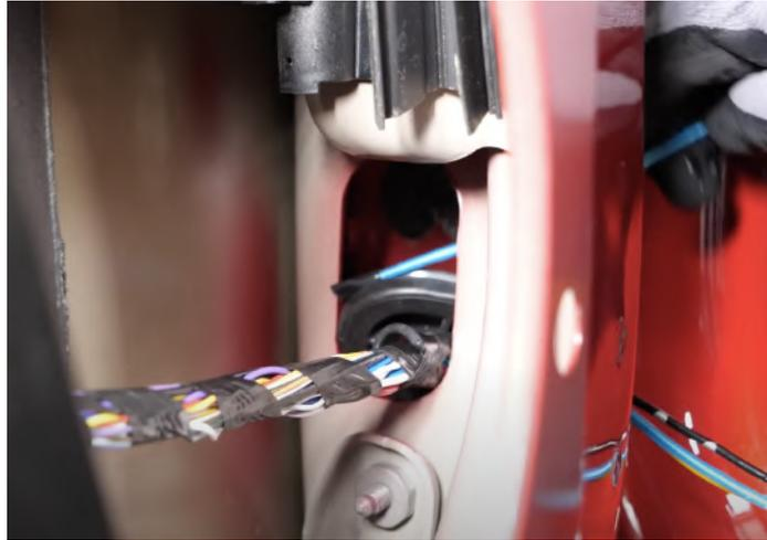
Abbildung 44: Durchführung von Strom- und Massekabel in die Tür
