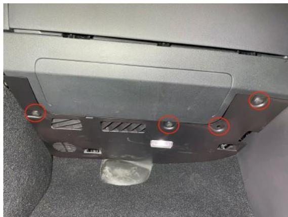
Abbildung 47: Befestigungen des Beifahrerfußraumes
