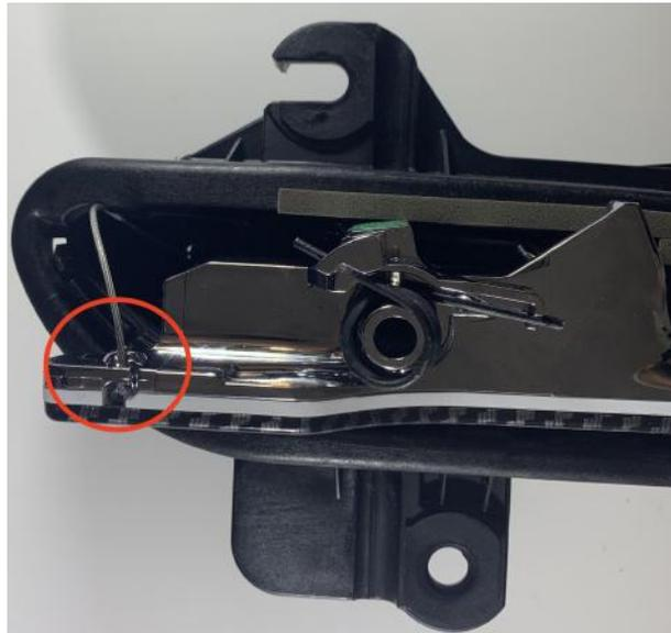
Abbildung 28: Anbringung des Bowdenzugs in die Haltevorrichtung
