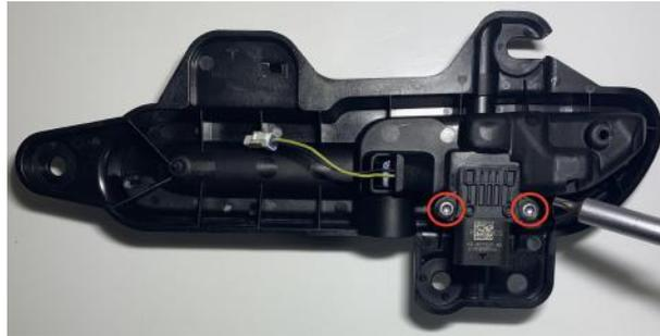
Abbildung 24: Verschraubungen des Anschlusses
