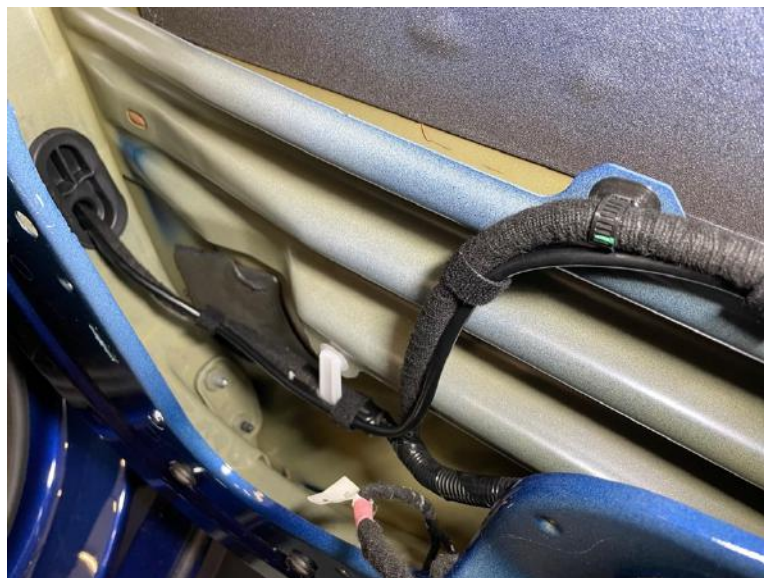
Abbildung 60: Kabelführung hintere Tür (1)
