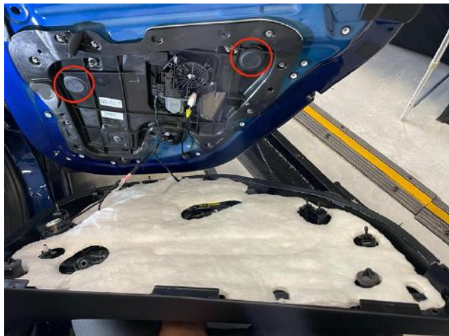
Abbildung 54: Gummidichtungen der Plastikverkleidung
