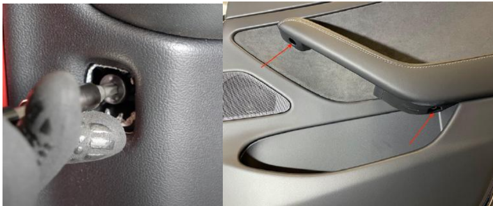
Abbildung 4 (links), Abbildung 5 (rechts): Zu entfernende Schrauben der Türverkleidung
