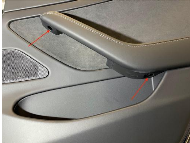
Abbildung 53: Befestigungsschrauben der hinteren Tür
