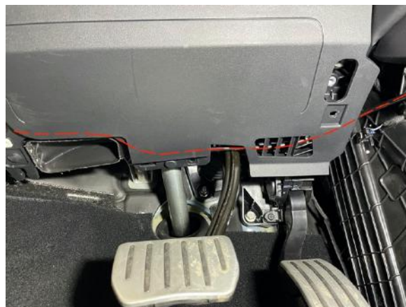
Abbildung 37: Kabelführung entlang des Fahrerfußraums
