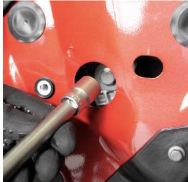
Abbildung 13: Entfernen der Schrauben in der Fensterfassung
