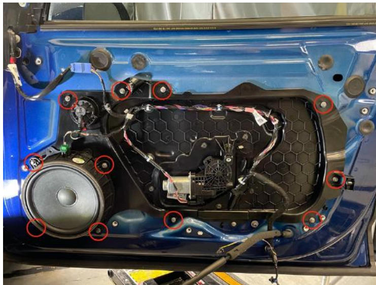
Abbildung 16: Zu entfernende Schrauben der Plastikverkleidung
