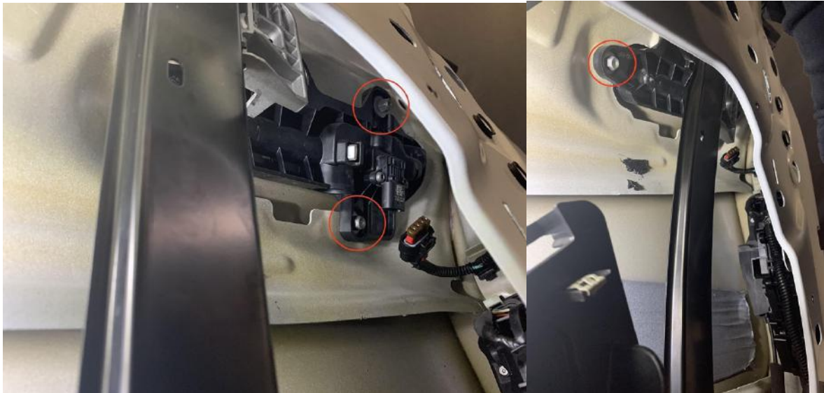
Abbildung 16: Zu lösende Schrauben des Türgriffs
