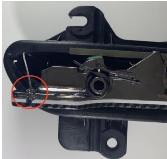
Abbildung 27: Anbringung des Bowdenzugs in die Haltevorrichtung
