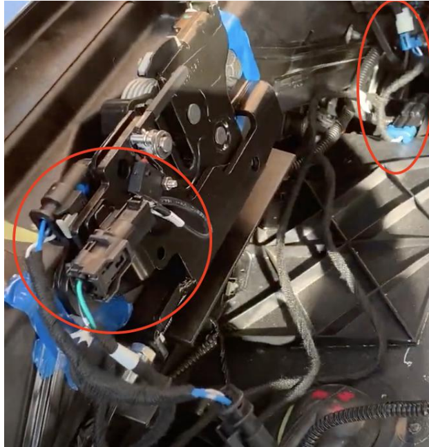
Abbildung 23: Steckerverbindung des Schlosssignals, Mikrotasters (links im Bild) und Schlossmotors (rechts im Bild)
