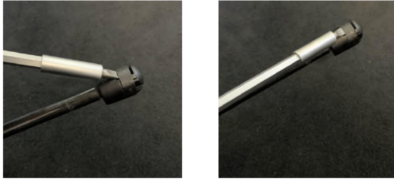
Abbildung 6: Hebeln des Sicherungssplints am Hubarm
