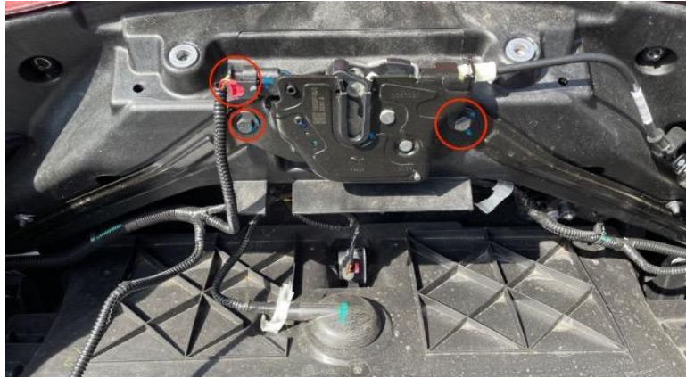
Abbildung 9: Stecker und Sechskantschrauben
