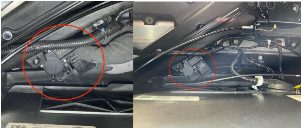
Abbildung 18 (links) und 19 (rechts): Anbringung Softclose Motor
