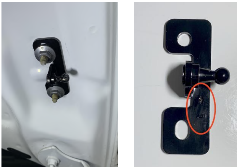
Abbildung 7: Anbringung der Adapterplatte für die Hubarme (links), Markierungen auf der Adapterplatte (rechts)
