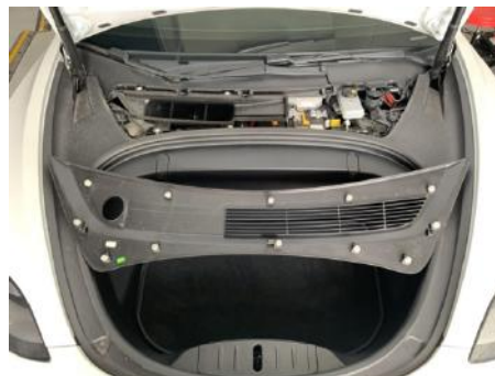
Abbildung 1: Klemmen der Plastikverkleidung
