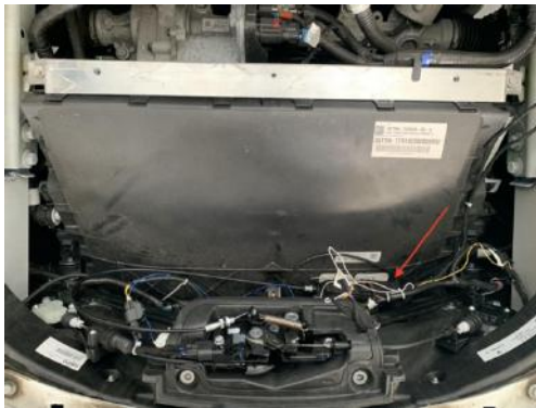
Abbildung 16 und 17: Anbringung des Bowdenzugmotors
