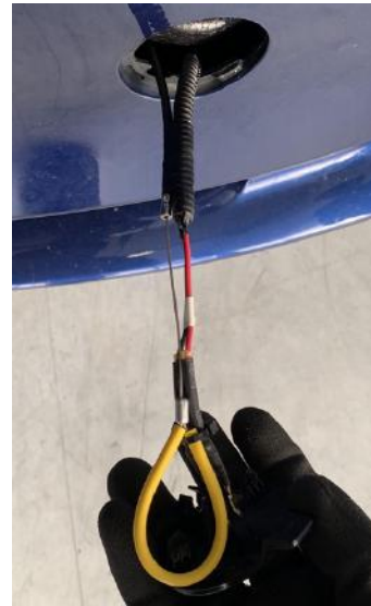
Abbildung 20 und 21: Abschleppkappe und Befestigung für Notbowdenzuglasche
