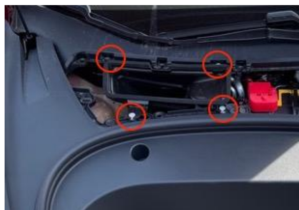
Abbildung 2: Klemmen der Plastikverkleidung
