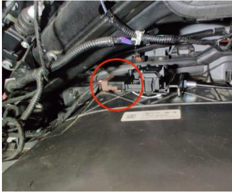
Abbildung 24: Braunfarbener Stecker am Bowdenzugmotor
