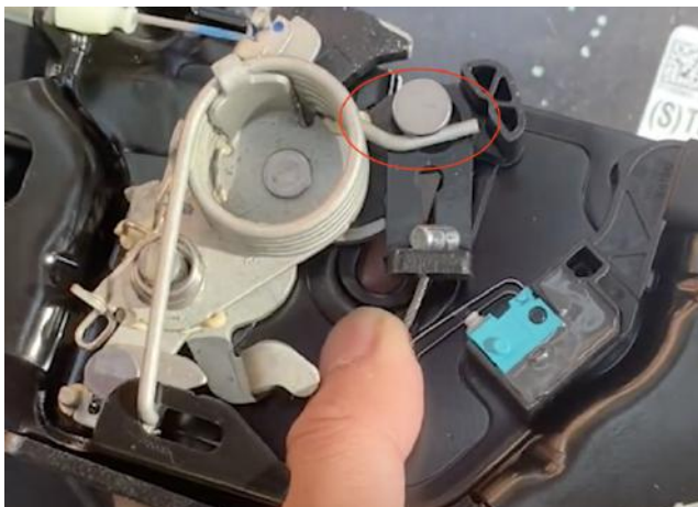
Abbildung 15: Wiedereinspannen der Feder
