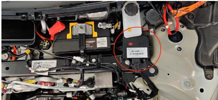
Abbildung 22: Anbringung der Steuereinheit
