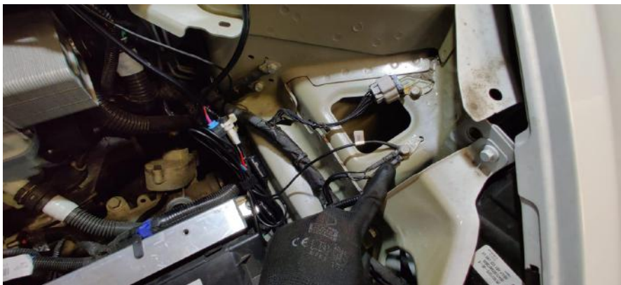
Abbildung 26: Schraube zum Abgreifen der Masse
