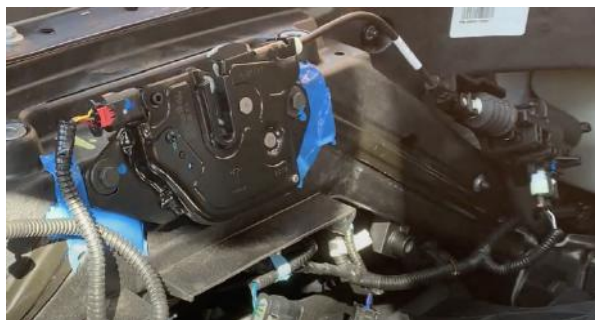
Abbildung 8: Markierung der Schlossposition
