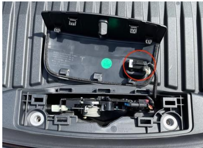
Abbildung 3: Klemmen der Schlossverkleidung
