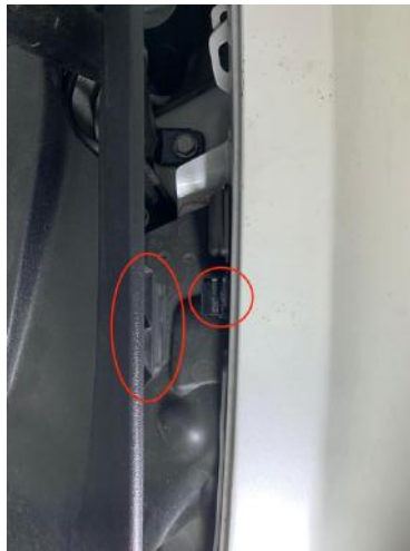
Abbildung 5: Klemme am Rand der Plastikverkleidung
