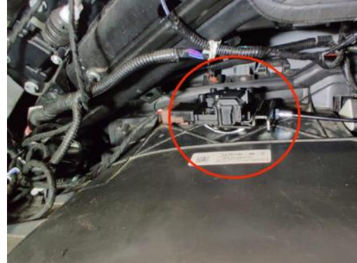
Abbildung 16 und 17: Anbringung des Bowdenzugmotors
