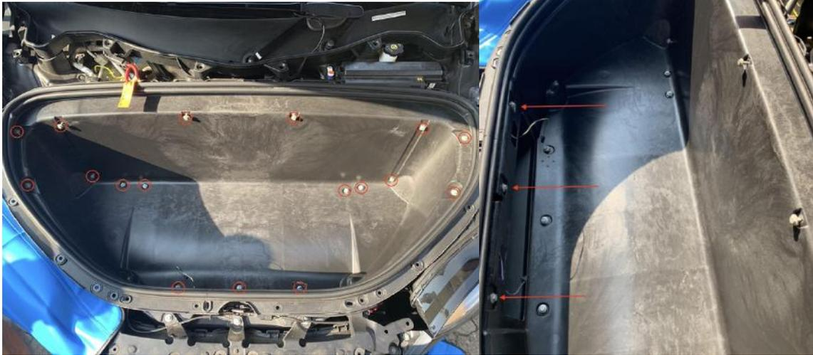
Abbildung 2: Verschraubung der Plastikwanne
