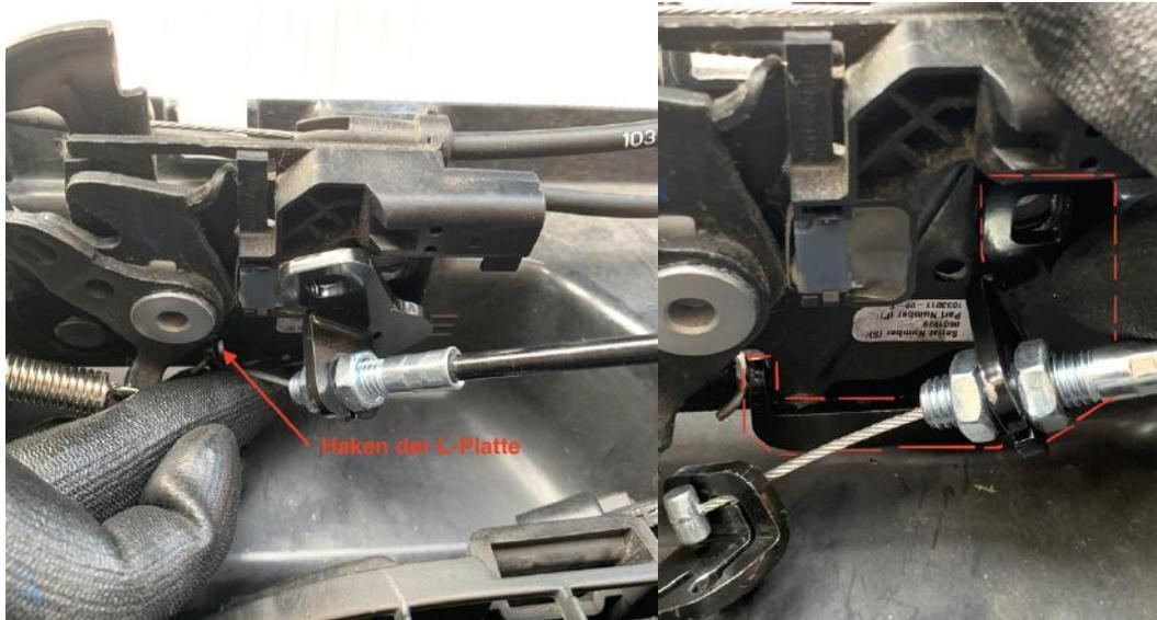
Abbildung 9: Anbringung der Einhakvorrichtung
