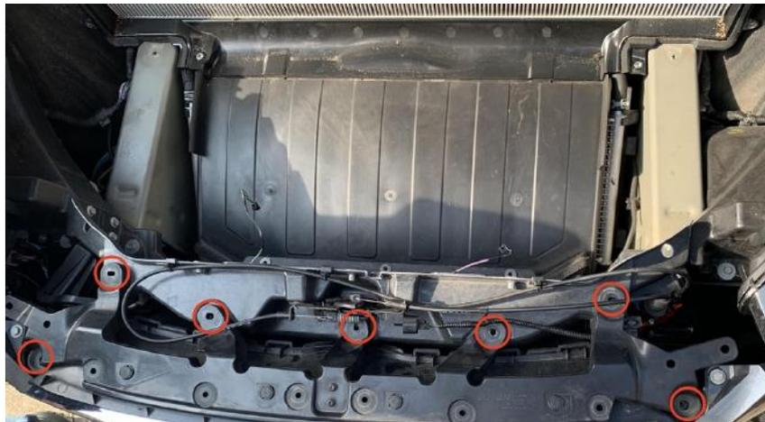
Abbildung 6: Verschaubung der vorderen Plastikverkleidung
