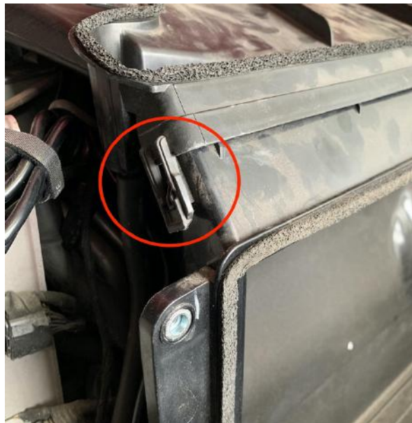
Abbildung 4: Sicherung des Filters
