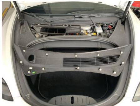
Abbildung 1: Klemmen der Plastikverkleidung
