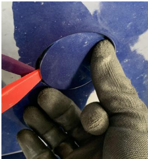
Abbildung 15 und 16: Abschleppkappe und Befestigung für Notbowdenzuglasche
