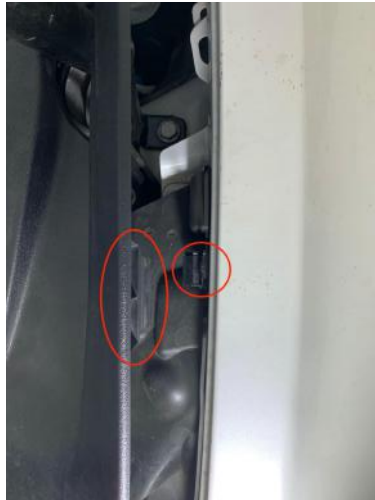
Abbildung 6: Klemme am Rand der Plastikverkleidung
