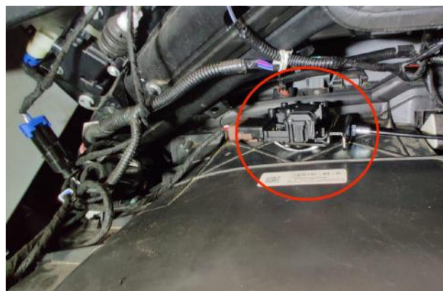
Abbildung 12 und 13: Anbringung des Bowdenzugmotors
