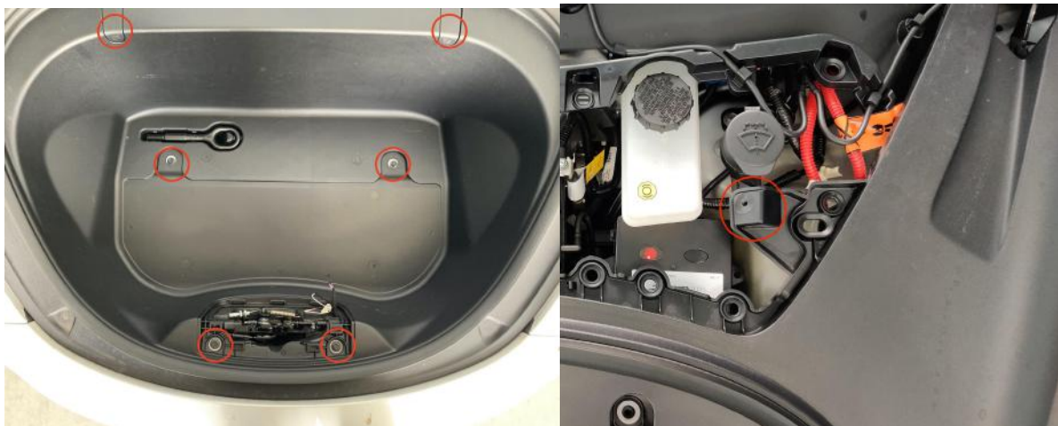
Abbildung 4 (links) und 5 (rechts): Schrauben der Wannerverkleidung
