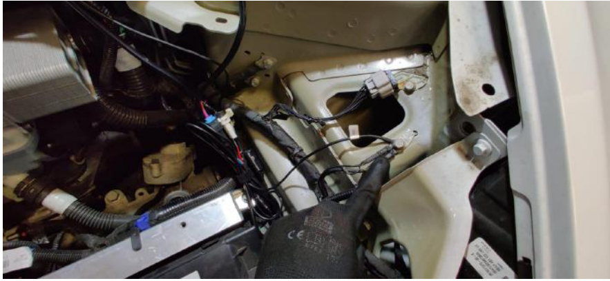
Abbildung 23: Schraube zum Abgreifen der Masse
