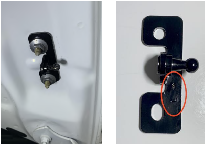
Abbildung 8: Anbringung der Adapterplatte für die Hubarme (links), Markierungen auf der Adapterplatte (rechts)
