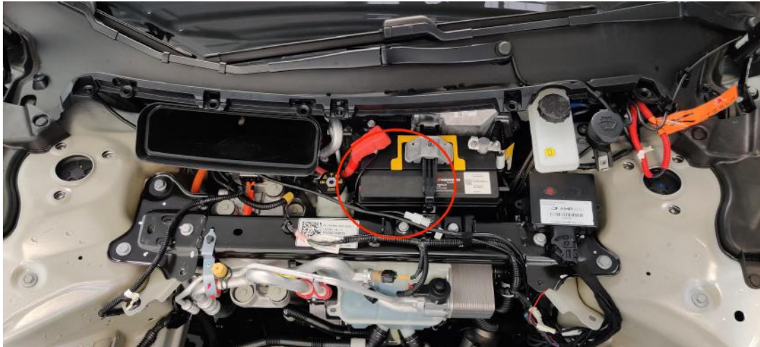
Abbildung 22: Stromadapterkabel am positiven Pol der Batterie
