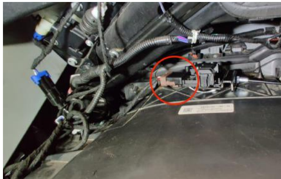
Abbildung 21: Braunfarbener Stecker am Bowdenzugmotor
