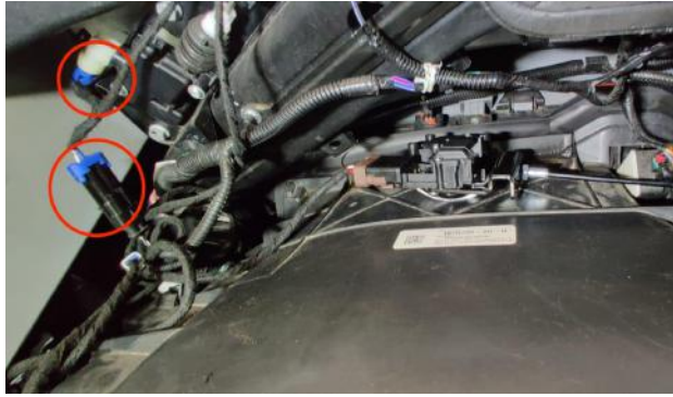
Abbildung 20: Steckerverbindung des Schlossmotors
