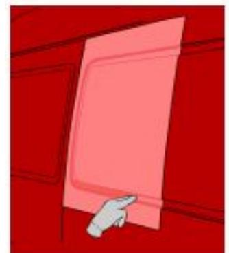
11. Prüfen Sie, ob Lufteinschlüsse vorhanden sind. Wenn noch kleine Blasen zu sehen sind, kann man sie ganz einfach entfernen: Stechen Sie ein sehr feines Loch ins Material, erhitzen Sie es (40-50° C) und drücken Sie die Luft heraus.
