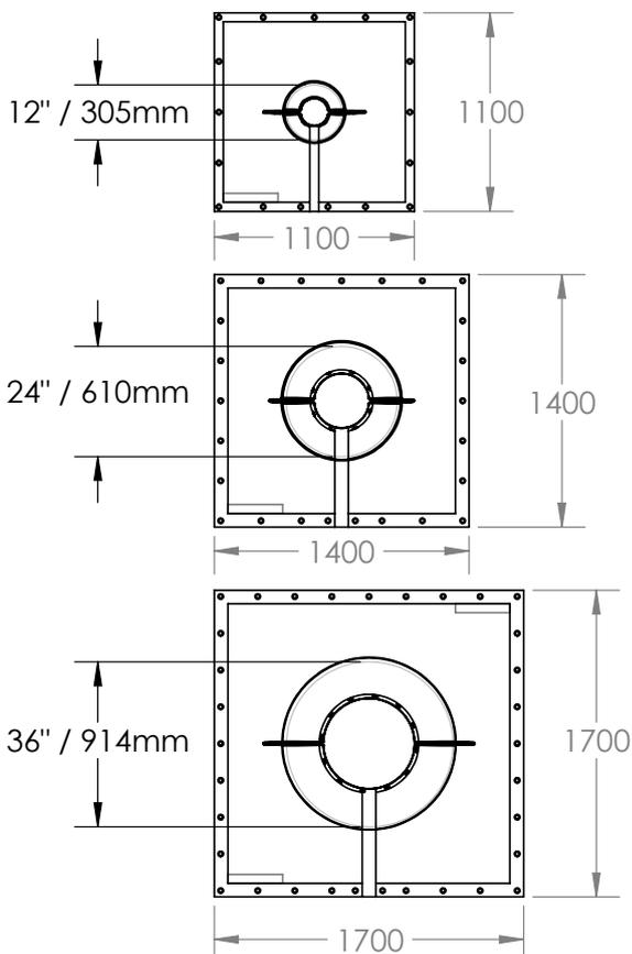
Der GRIPPS Gap Wrap ist ein einzigartiges Einkapselungsgerät, das zur Beseitigung von Lücken um Rohre herum entwickelt wurde, die vertikal durch Baustellenböden verlaufen.
