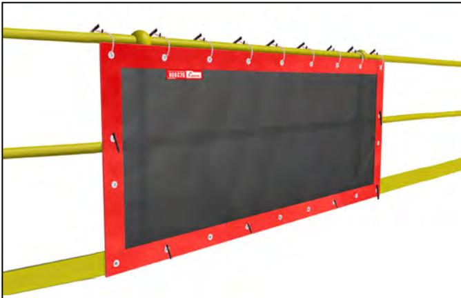
Der GRIPPS Gap Screen ist eine wirtschaftliche, feuerbeständige Fallschutzbarriere für Handläufe. Der Gap Screen ermöglicht dem Personal das Arbeiten auf Plattformen in der Höhe und schützt gleichzeitig seine Werkzeuge und Ausrüstung vor dem Herunterfallen von Plattformkanten. Der Gap Screen wird mit Kabelbindern (oder ähnlichem) über die 22 verfügbaren Edelstahlösen befestigt.
