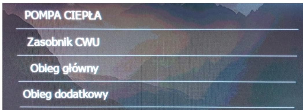
Wenn die Taste „Wärmepumpe“ gedrückt wird, werden solche Betriebsparameter der Wärmepumpe angezeigt wie Speisetemperatur und Rücklaufemperatur von Wasser, Saug- und Drucktemperatur des Betriebsmediums, Verflüssigungstemperatur, Verdampfungstemperatur und Außentemperatur. Zusätzlich sind hier die Daten des Kompressors zu sehen, z. B. Betriebsleistung, Anzahl der Einschaltvorgänge, Betriebsstunden des Kompressors, Anzahl der Einschaltvorgänge vom Defrost usw.
