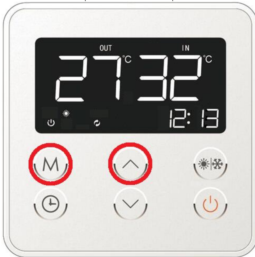
Abb. 14a. Ausschalten der Elektroheizpatrone des Brauchwasserspeichers.
