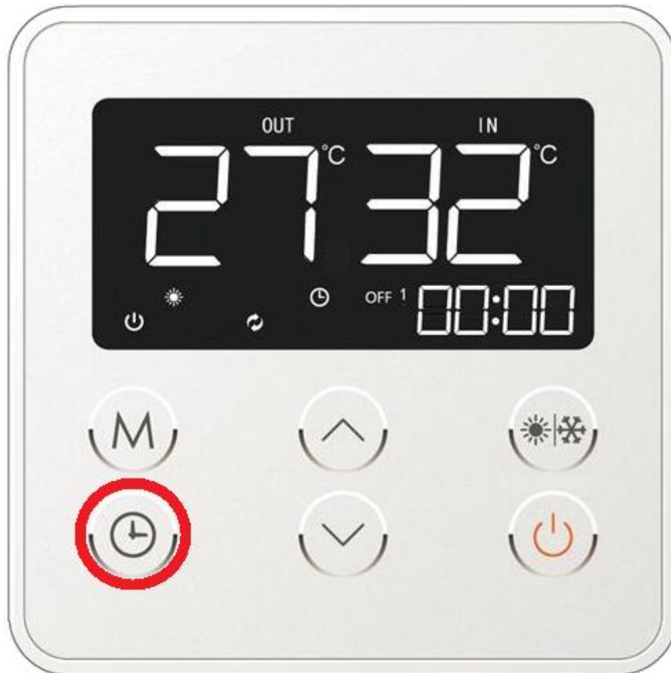
Abb. 12e. Bestätigung der Einschaltzeitwerte mit gleichzeitigem Übergang zu den Ausschaltzeitparametern der Wärmepumpe.
