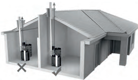
Bild 3. Richtige und falsche Kaminparameter des Kesselanschlusses SLX
