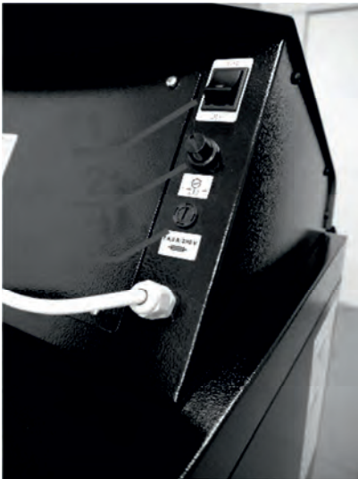
Bild 17. 1 – Hauptschalter, 2 – Havarie Thermostat, 3 – Sicherung (F6,3A)
