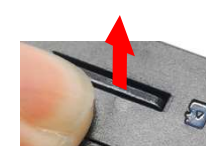
少し飛び出してきたら引き抜く
