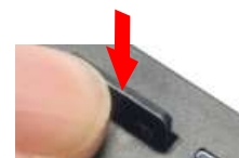
microSDカードを軽く押し込み
