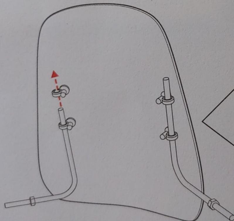
将风挡固定杆插入固定扣件，
