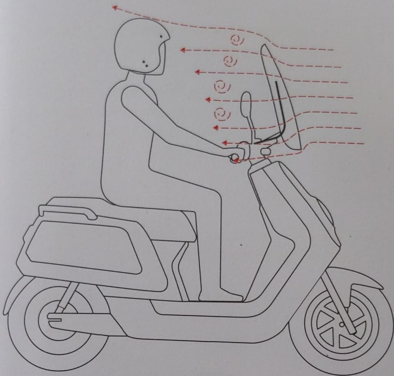
风挡能有效减少高速气流对身体的影响，提高骑行舒适度。可以防止飞溅的物体直接击中人体，保证骑行安全。骑行时需配带安全头盔。
