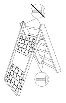
Dreieckseparat nur mit der Spreizsicherung benutzen
