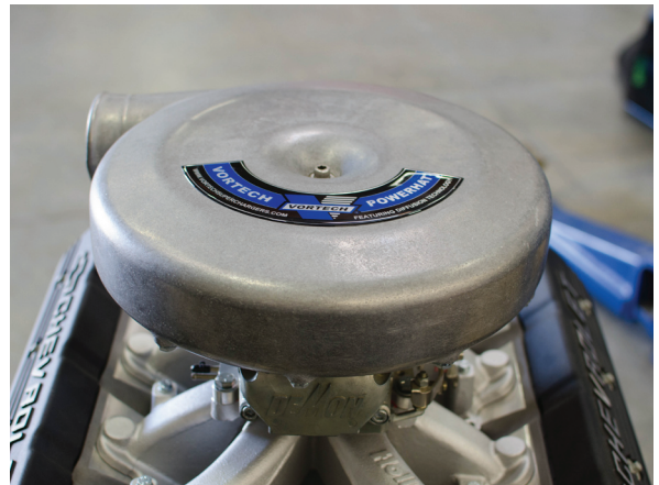
Fig. 4-e: Secure Carburetor Hat
