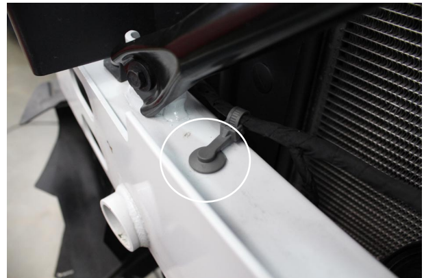
Fig. 1-q: Remove Plastic Tabs
