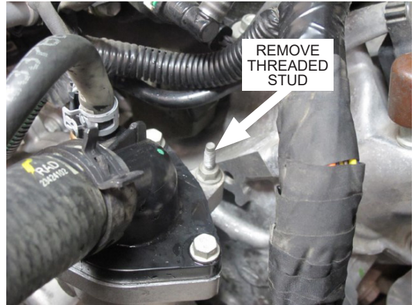
Fig. 1-J: Remove threaded stud
