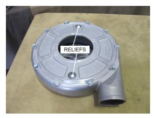
Fig. 7-B: Reinstall carburetor hat base
