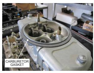
Fig. 7-C: Install carburetor hat gasket
