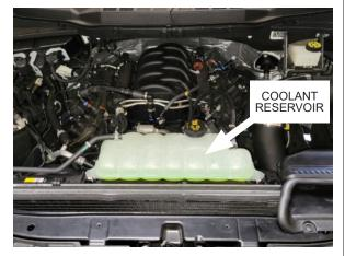
Fig. 7-B: Refill coolant
