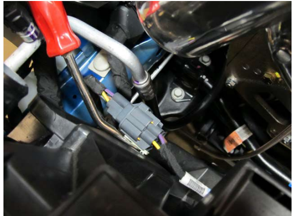
Fig. 4-m: Detach Cooling Fan Connector From Fan Shroud
